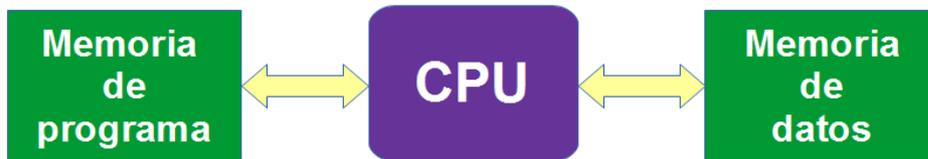
Figura 7. Arquitectura del microcontrolador, arquitectura Harvard.
