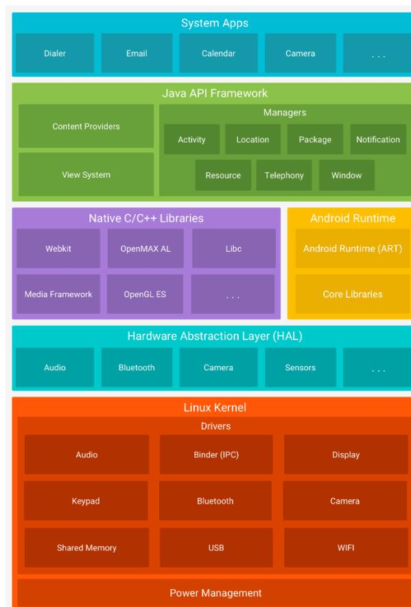
Figura 21. Componentes principales de la plataforma Android.
