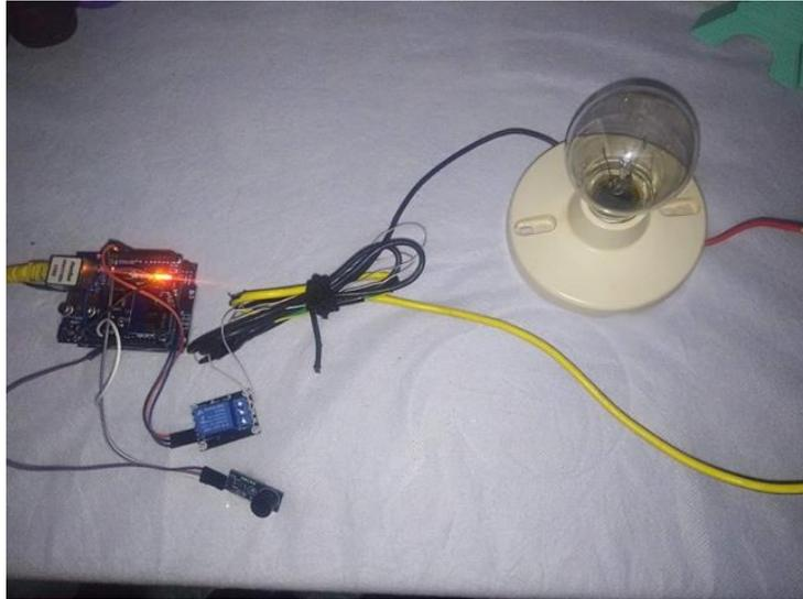
*Figura 34.* Integración de Arduino, Shield Ethernet, relé, sensor de alarma y bombilla.
