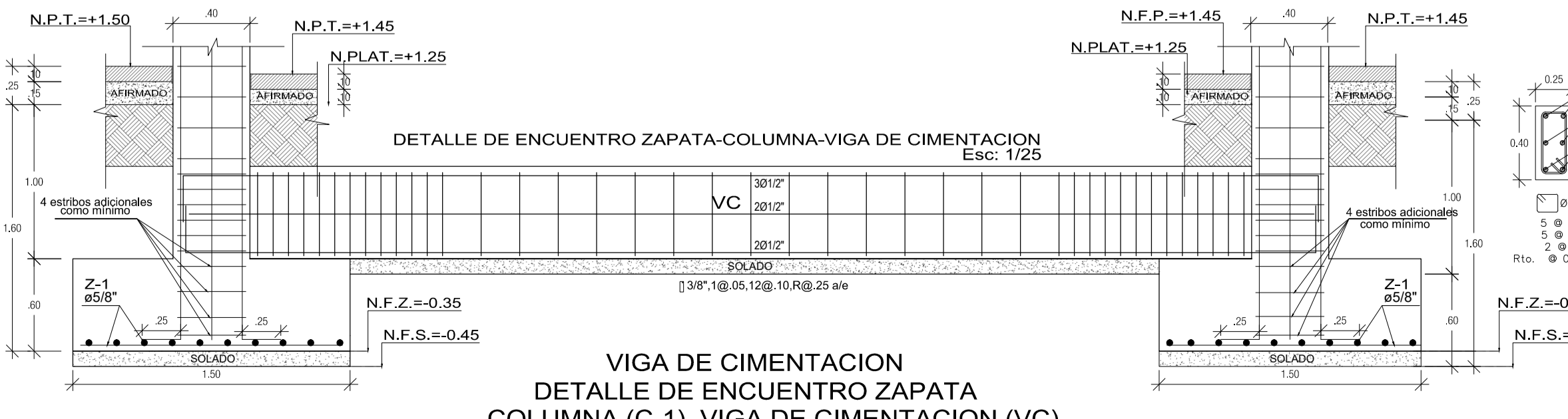
DETALLE DE ENCUENTRO ZAPATA-COLUMNA-VIGA DE CIMENTACION ESCALA: 1/25
