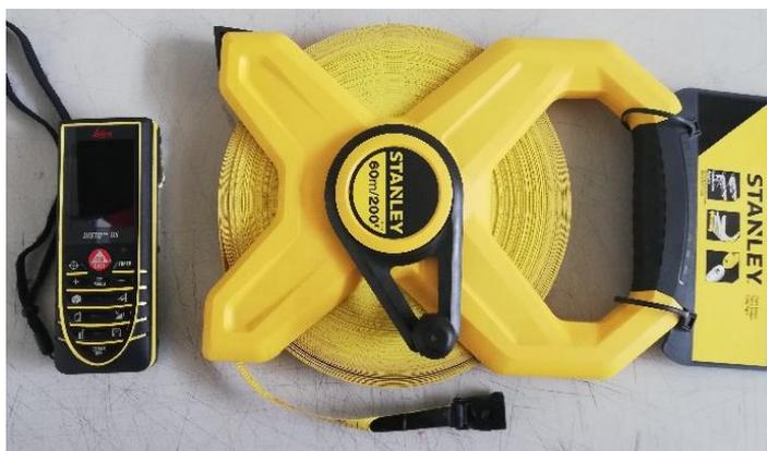
Figura 36. Distanciometro y flexómetro usados en la caracterización de las edificaciones
