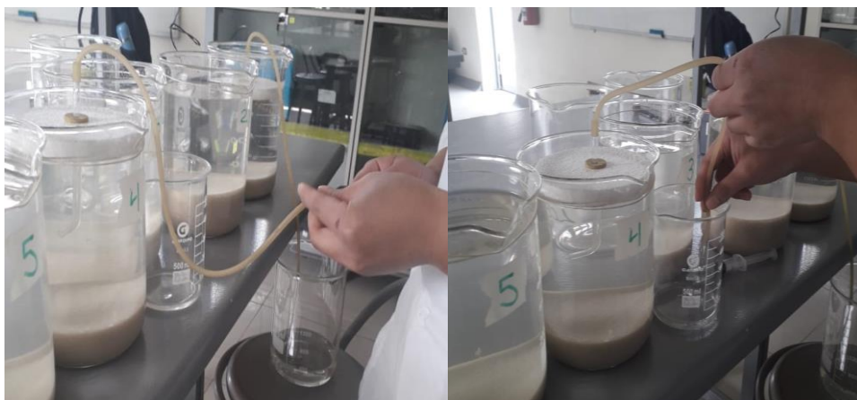
Figura 48. Retiro de los 10mL del agua atrapada en el sifón, pasado los cinco minutos del proceso de sedimentación.
