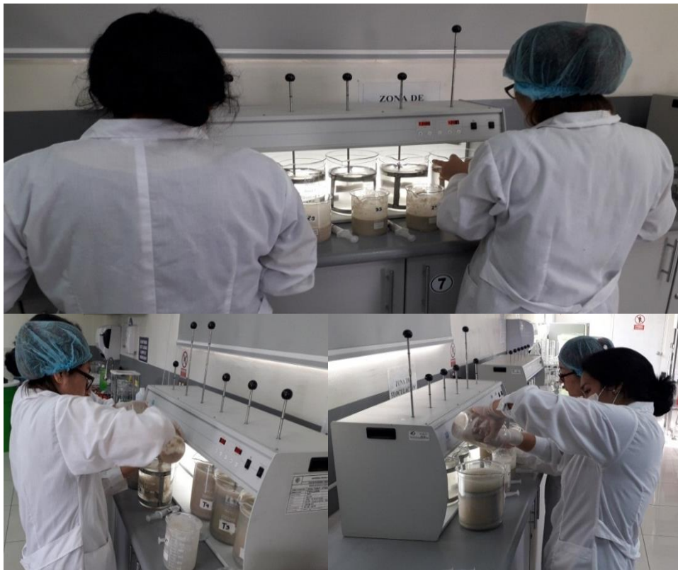
Figura 44. Ejecución de la prueba de jarra.
