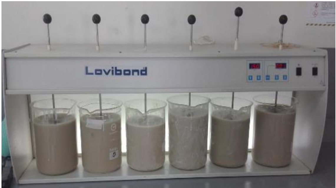
Figura 71. Prueba de jarra de la mezcla de arcilla bentonita a 300 RPM durante 10 minutos.
