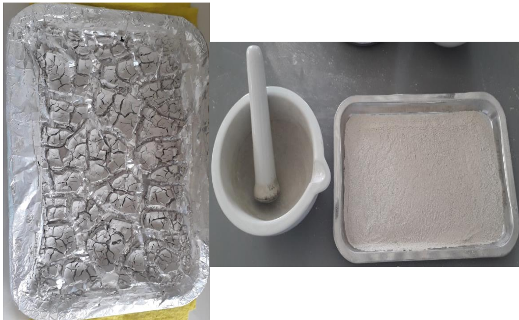
Figura 74. Secado de la arcilla centrifugada y molienda de la montmorillonita hasta lo más fino.
