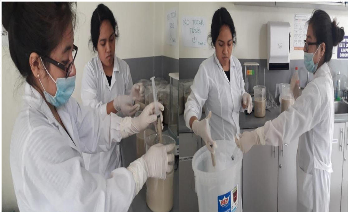
Figura 72. Extracción de la solución sobrenadante hasta una profundidad de 10 cm.
