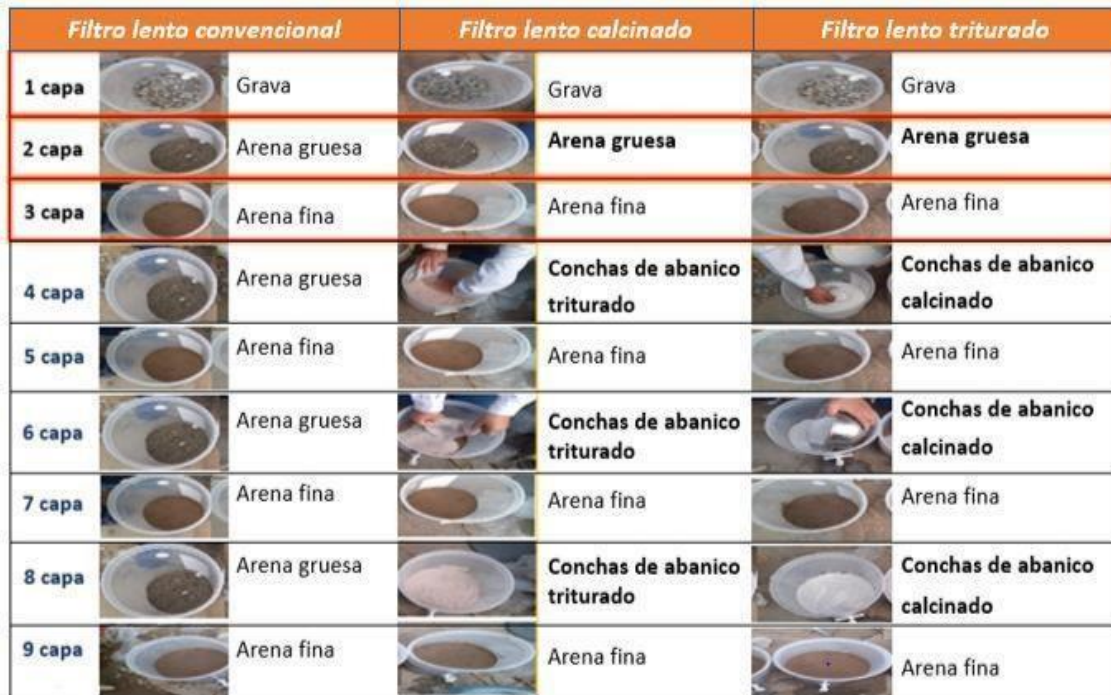
Figura 6. Construcción de las capas en cada uno de los filtros.
