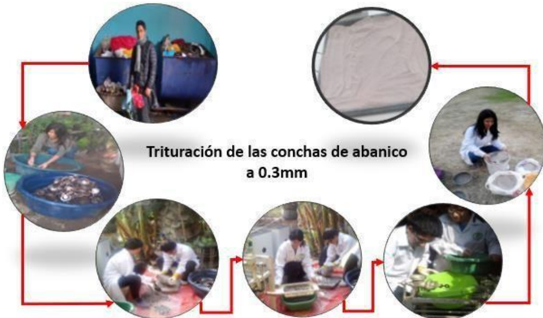
Figura 3. Triturado, cernido, molido y calcinado del Argopecten purpuratus .
