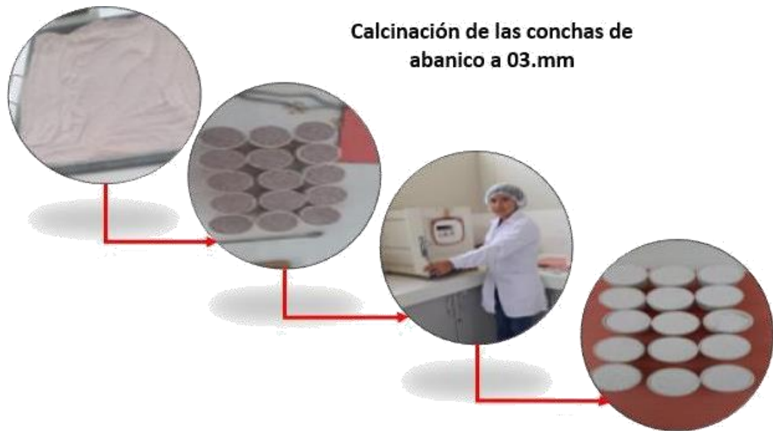
Figura 4. Calcinación de las conchas de abanico
