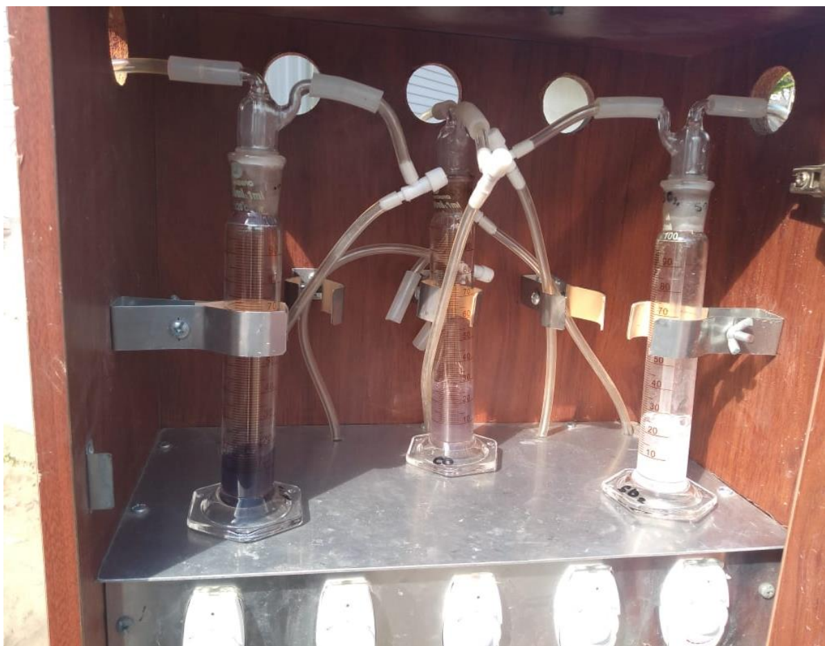
Anexo 5.3 Captación de gases contaminante por método de succión a través de soluciones captadoras
