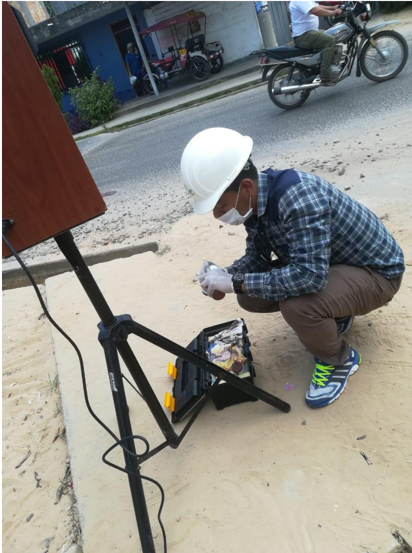
Anexo 5.2 Traspase de las soluciones captadoras a los springers
