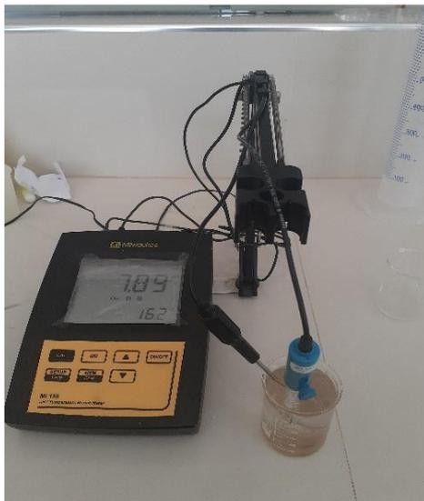
*Figura 9.* Potenciómetro de mesa modelo Mi 150
