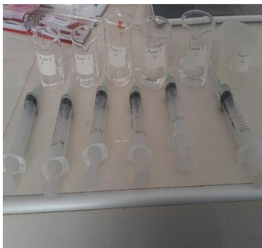
*Figura 5.* Solución de  $\text{Al}_2(\text{SO}_4)_3$  a distintas dosis
