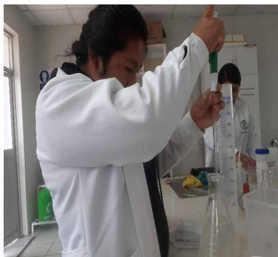
*Figura 11.* Medición de dosis de sulfato de aluminio  $\text{Al}_2(\text{SO}_4)_3$
