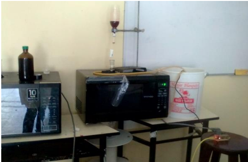
Figura 5. Concentración de antocianinas asistida microondas refrigerante
