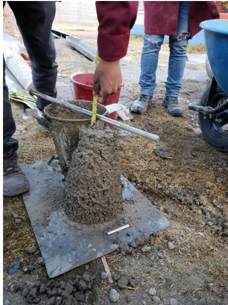
Fotografía 3: Ensayo de Slam Fuente: Elaboración Propia
