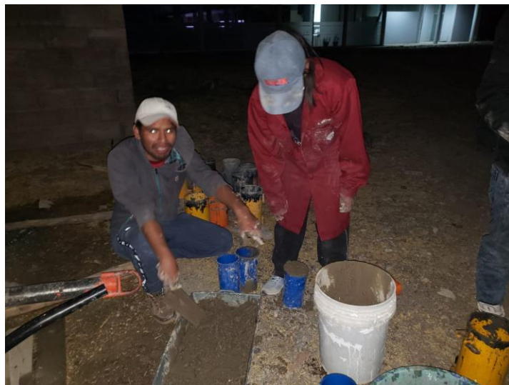
Fotografía 4: vaciando la mezcla a las briquetas Fuente: Elaboración Propia
