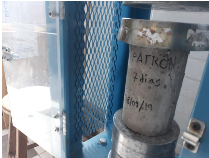
Fotografía 5: Ensayo a la Resistencia de Compresión Fuente: Elaboración Propia
