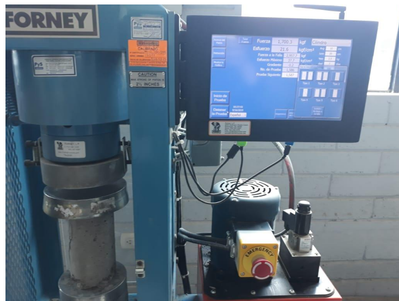
Fotografía 6: Resultados obtenidos por la prensa de Compresión. Fuente: Elaboración Propia
