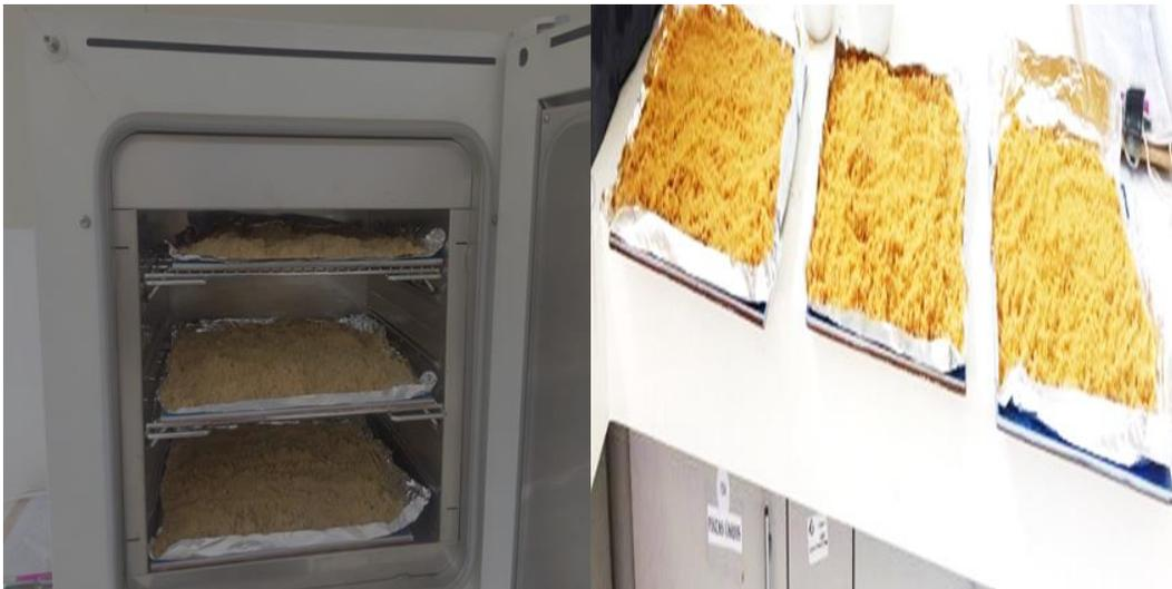
*Figura 98. Secado de biomasa celulósica en estufa por 24 horas a 80 °C*
