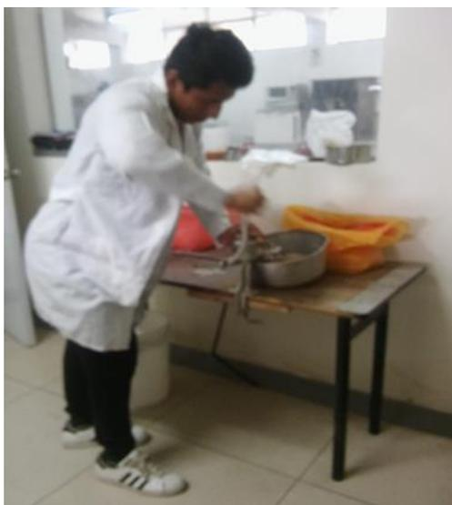
*Figura 89. Molienda con molino manual*
