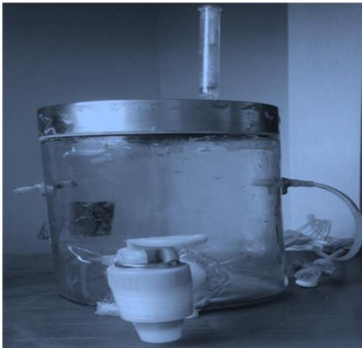
*Figura 88.* Biorreactor anaerobio para la fermentación
