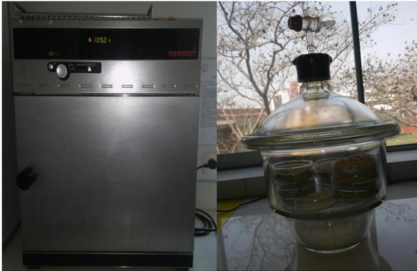
*Figura 92.* Determinación de cenizas por método AOAC,2000
