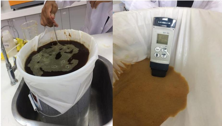
*Figura 95.* Lavado de biomasa deslignificada con agua destilada hasta tener un pH neutro
