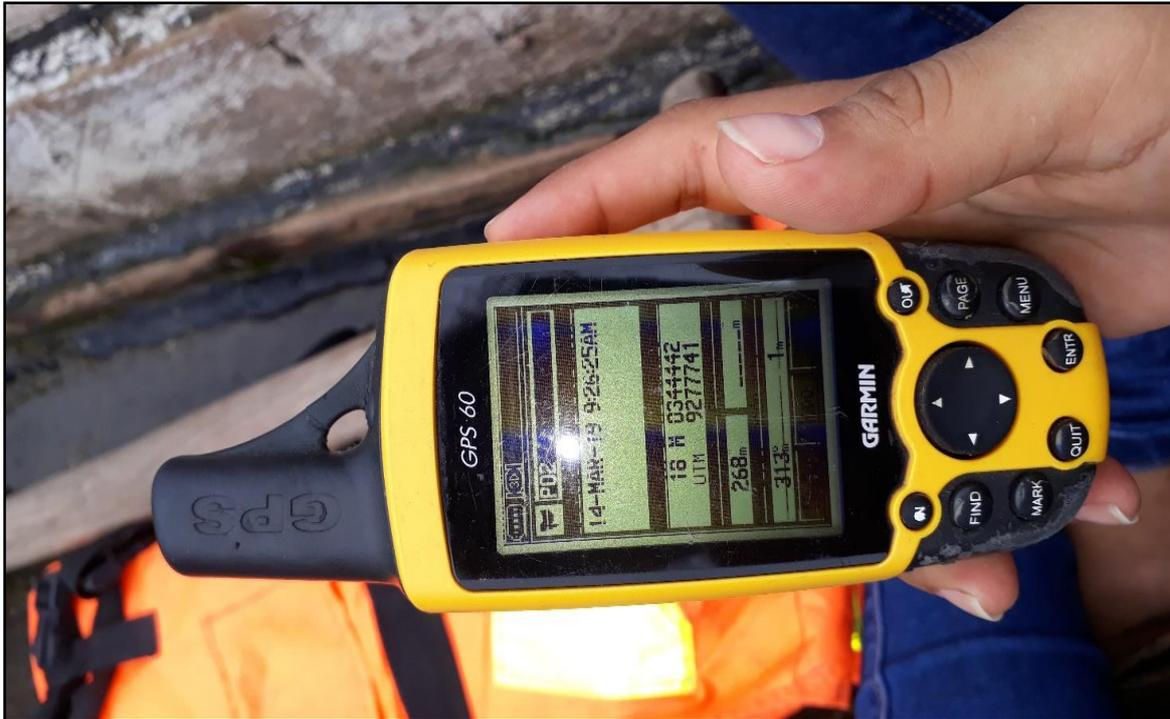
Georreferenciación de los puntos de muestreo (Uso del GPS).
