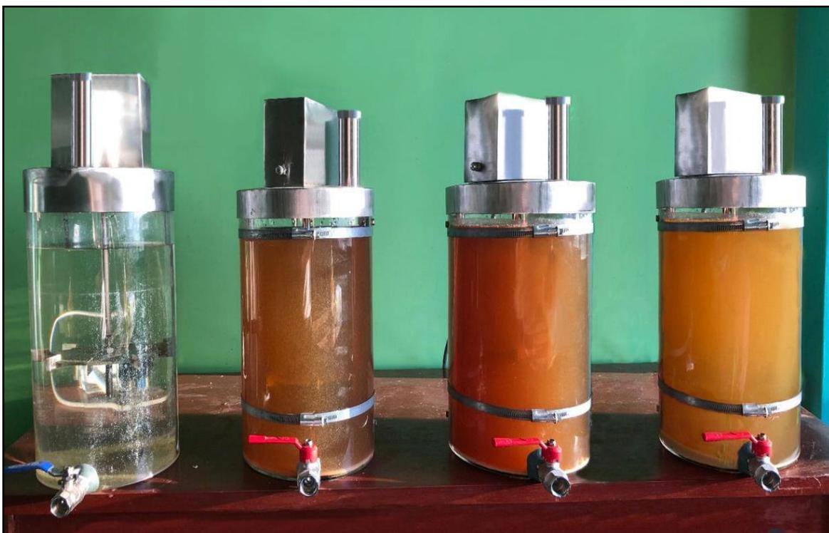
Reactores donde se realizó el ensayo (Blanco: A, 5% de EM: B, 10% de EM: C y Agua destilada con EM: D)
