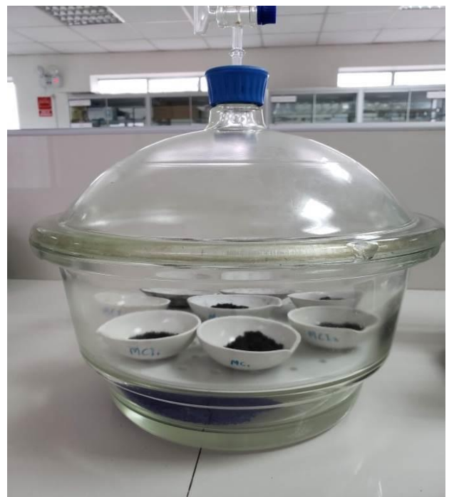
Figura 21: Desecador con las muestras sacadas de la estufa
