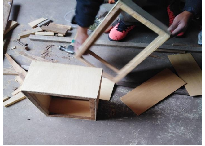
Figura 4: Construcción de las biopilas de madera
