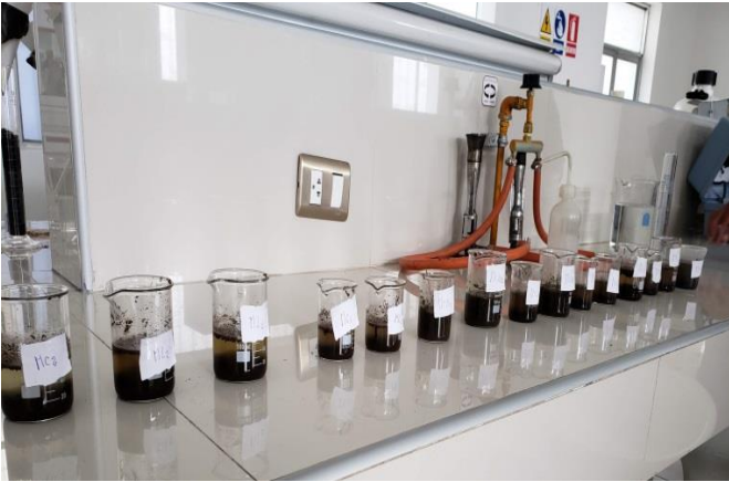
Figura 64: Sedimentación de la concentración para la lectura con el multiparámetro
