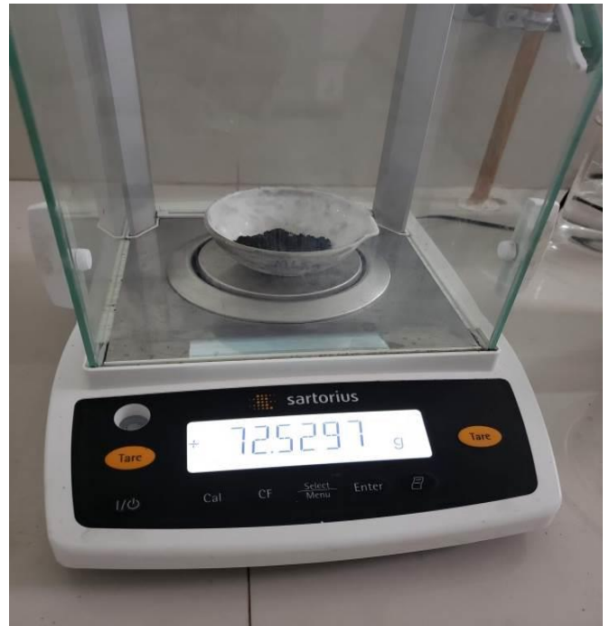
Figura 77: Peso de las muestras para determinar humedad
