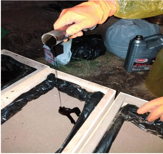
Figura 11: Contaminación de suelo con aceite lubricante residual
