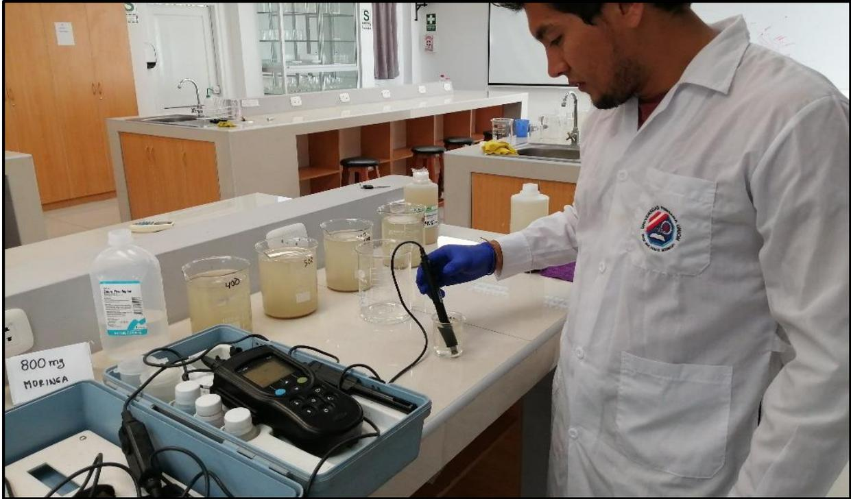
Medición de los parámetros después de terminado la sedimentación.
