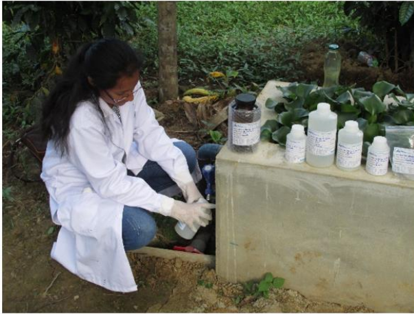
Imagen 13: Toma de muestra del agua residual domestica tratada por el humedal artificial con la macrófita Eichhornia Crassipes .
