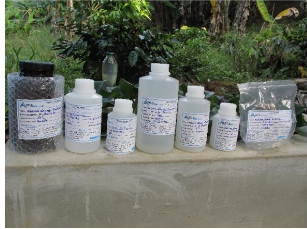
Imagen 13: Toma de muestra del agua residual domestica tratada por el humedal artificial con la macrófita Eichhornia Crassipes .
