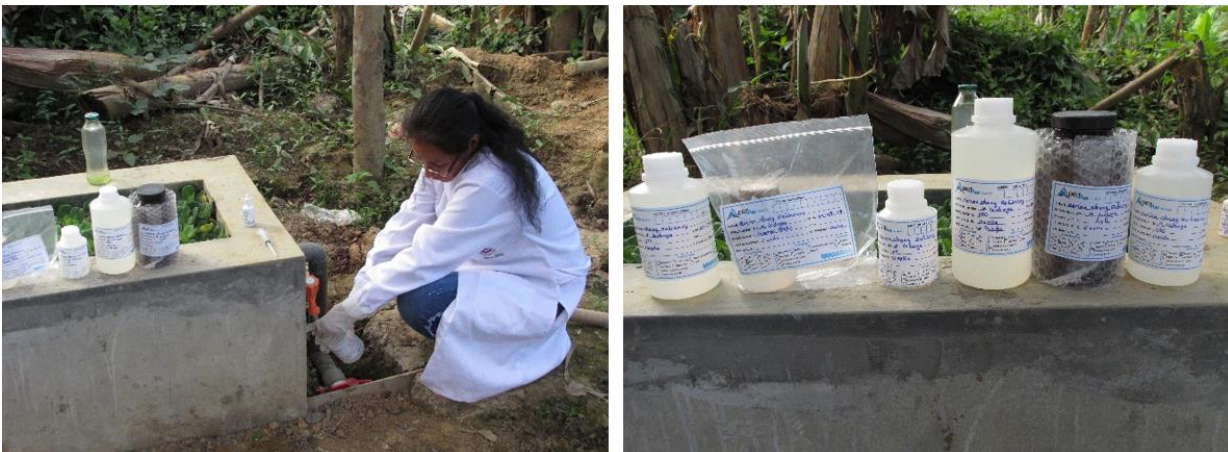
Imagen 12: Toma de muestra del agua residual domestica tratada por el humedal artificial con la macrófita Pistia Stratiotes .
