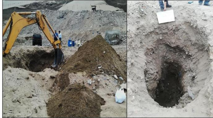
Figura 44. Excavación y muestreo de la calicata C-B
