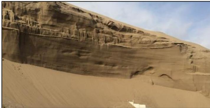
*Figura 17. Corte de la duna, material de arenas eólicas (SP), obsérvese la estratificación sesgada, producto de los diversos ángulos de deposición. (Fuente: Elaboración Propia)*
