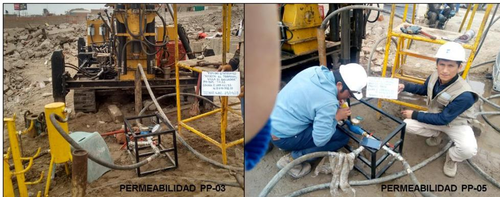
Figura 45. Prueba de permeabilidad Lefranc Puntos PP-03 y PP-05.
