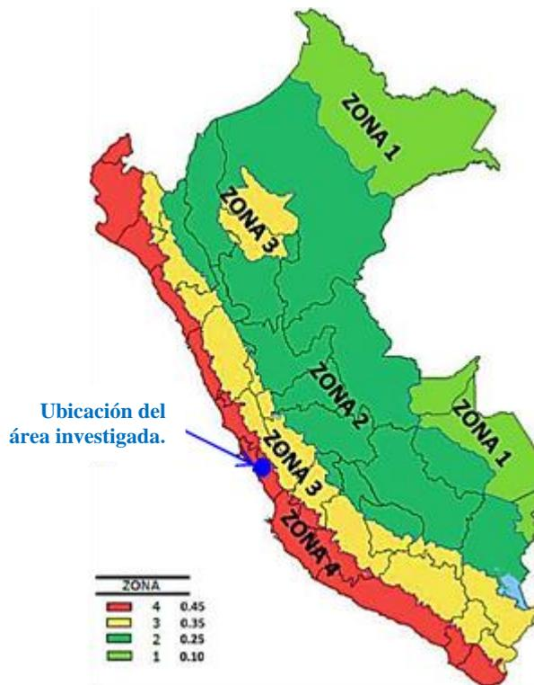
Figura 21. Zonas Sísmicas del Perú. (Fuente: Norma E.030 Diseño Sismoresistente, 2018).
