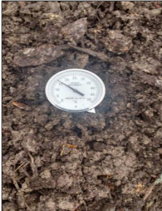
**Figura 19:** Medición de la temperatura en las pilas de compostaje
