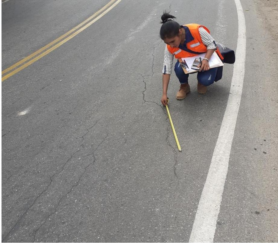
Figura 93: Fisuras transversales y peladura por intemperismo, unidad de muestreo U24
