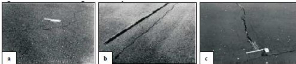
Figura 17: Fisuras de niveles de gravedad bajo (a), medio (b) y alto (c).
