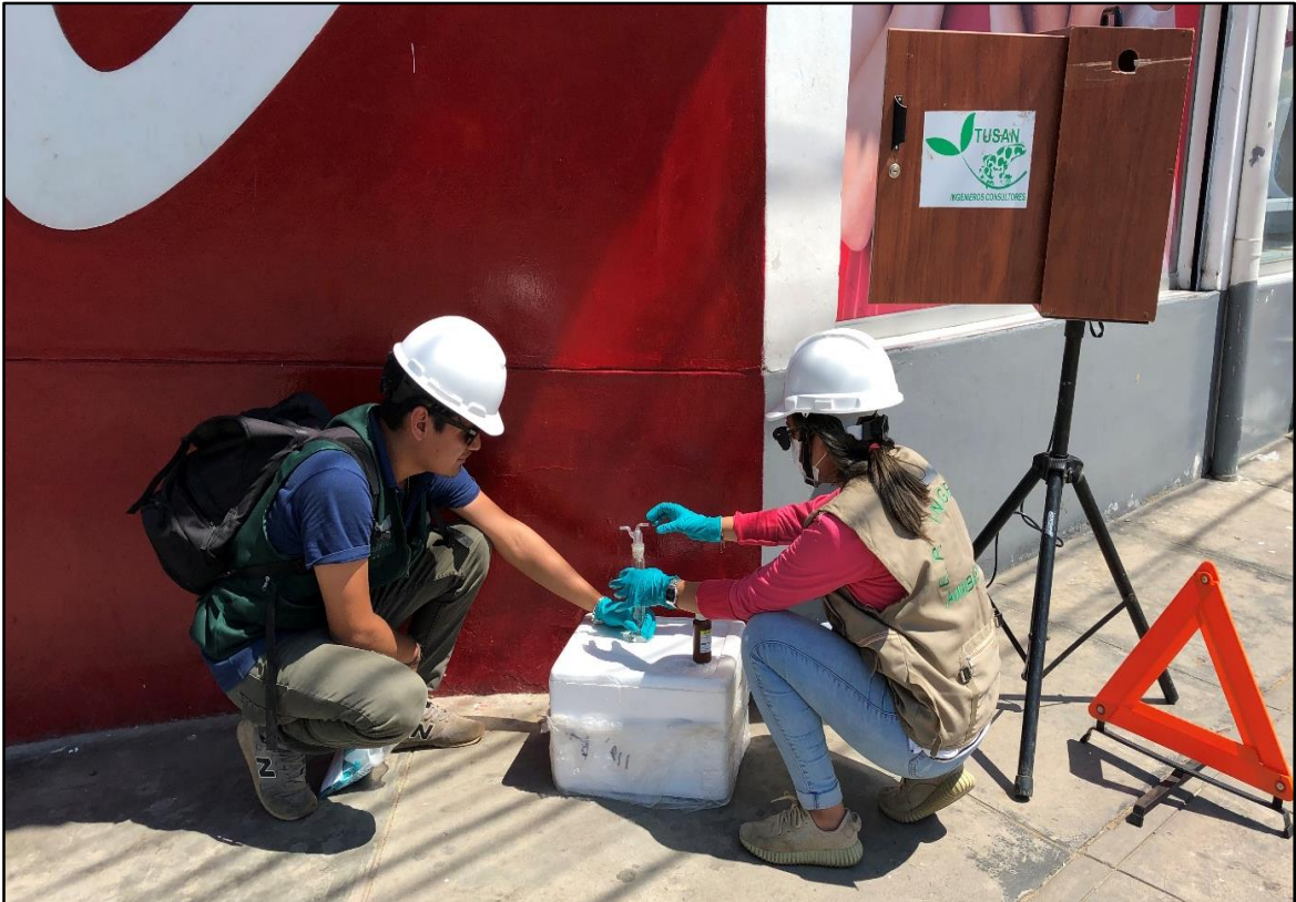
Soluciones captadoras en los tubos borboteadores - monitoreo de CO y H 2 S. Fuente: Elaboración propia, 2019.
