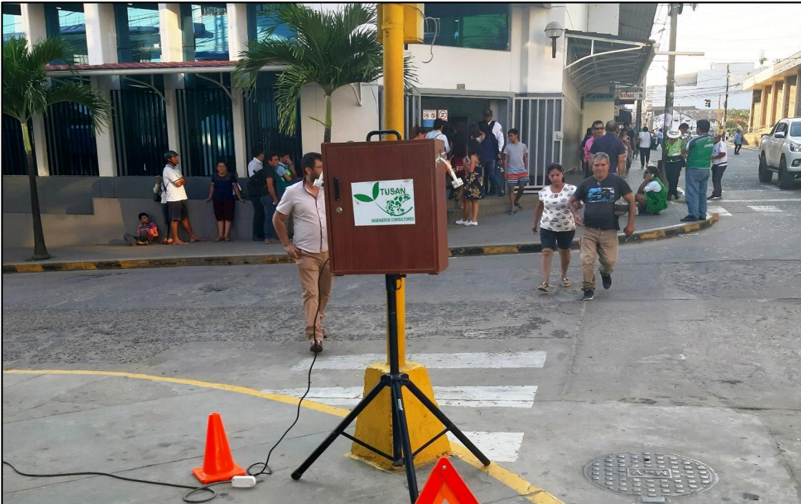
Monitoreo para la calidad de aire por CO y H 2 S en el punto E-03. Fuente: Elaboración propia, 2019.
