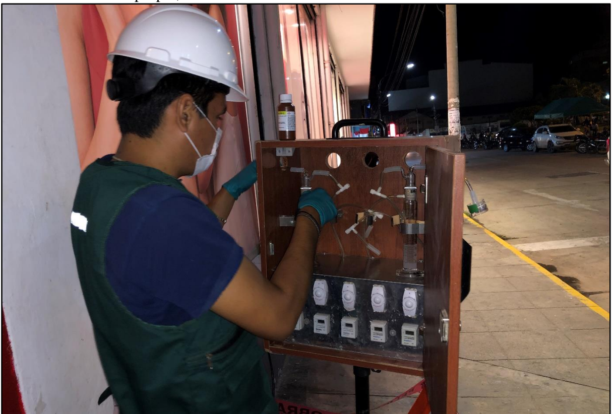
Instalación de los tubos borboteadores - monitoreo de CO y H 2 S en el punto E-01. Fuente: Elaboración propia, 2019.
