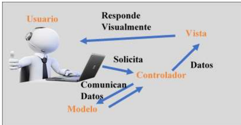
Figura 11 Diagrama de patrón Modelo Vista Controlador (Elaboración Propia)
