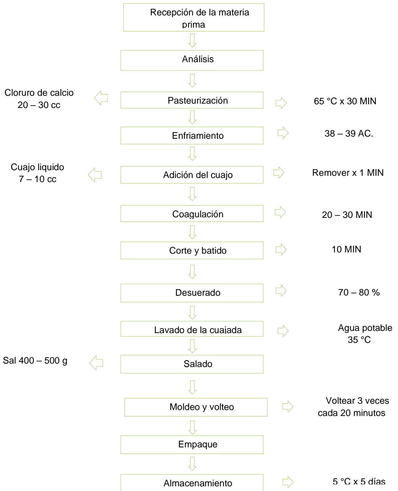
Figura 17. Diagrama de flujo, para la elaboración de queso.
