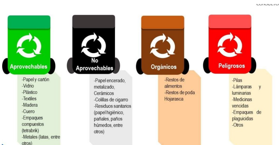
Figura 2. Clasificación de código de colores para la segregación de residuos sólidos, Norma Técnica Peruano - NTP 900.058 (2019). Lima: INDECOPI.
