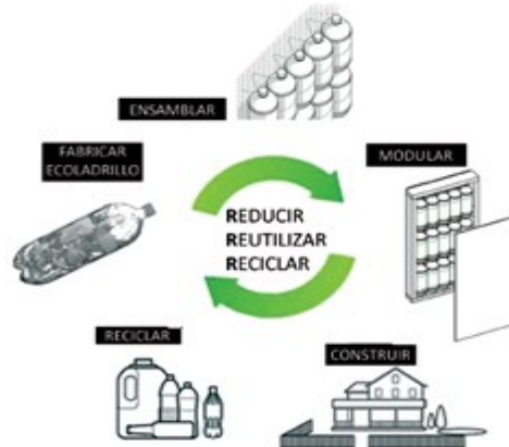
Figura 4. Proceso de reutilización de residuos inorgánicos con ecoladrillos (Gonzales & Rodas, 2015).
