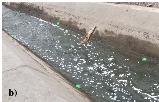
Figura 4. a) Grabación a diferentes alturas- ángulos. b) Sembrado con trazadores de esferas de poli estireno expandido de 1/2" c) Sembrado con trazadores de espuma de jabón líquido. Fuente: Los autores.
