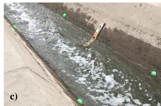
Figura 4. a) Grabación a diferentes alturas- ángulos. b) Sembrado con trazadores de esferas de poli estireno expandido de 1/2" c) Sembrado con trazadores de espuma de jabón líquido. Fuente: Los autores.
