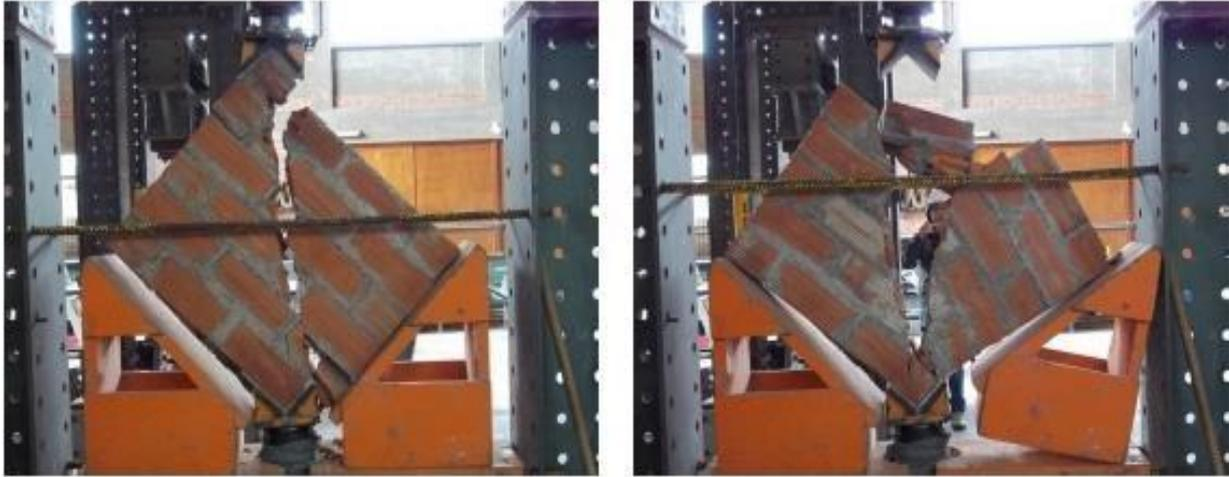
Figura 3: Se observa el ensayo a compresión diagonal de muretes de 0.60 X 0.60 m2.
