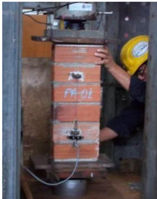
*Figura 2: Se observa el ensayo a compresión de las pilas.*
