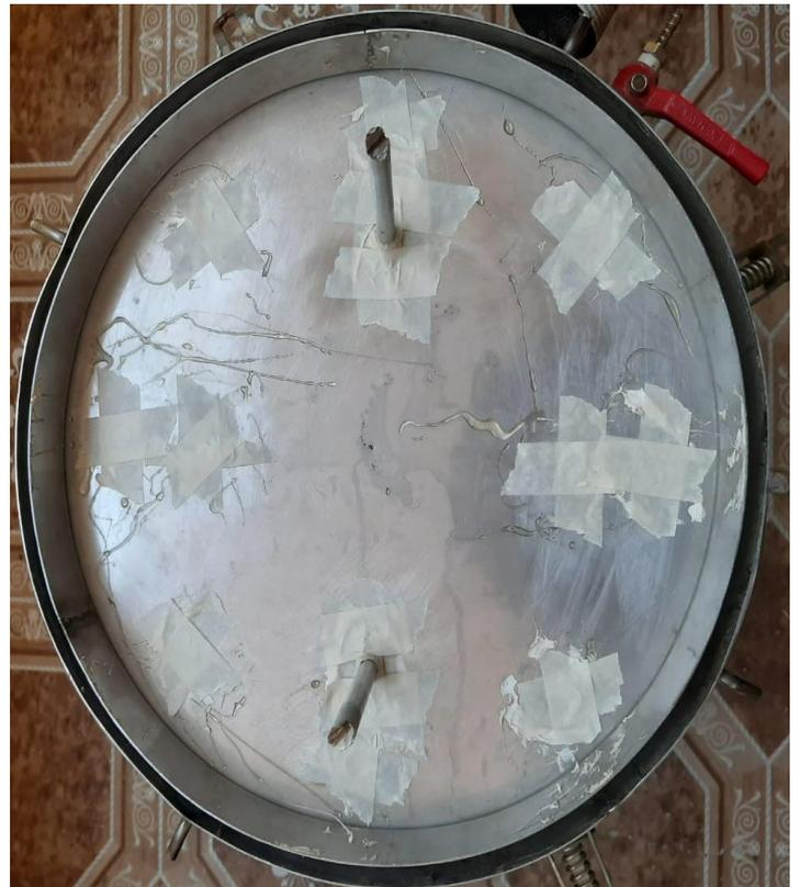
*Figura 12. Tapa y fuente de alimentación del EF.*
