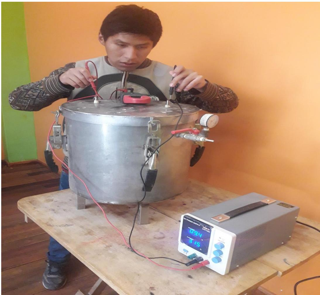
Figura 15. Ejecución del tratamiento, medición de los voltajes aplicados al electrofiltro (EF).
