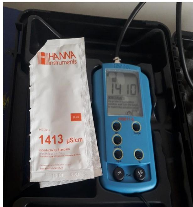
Figura 20. Calibración de la CE
