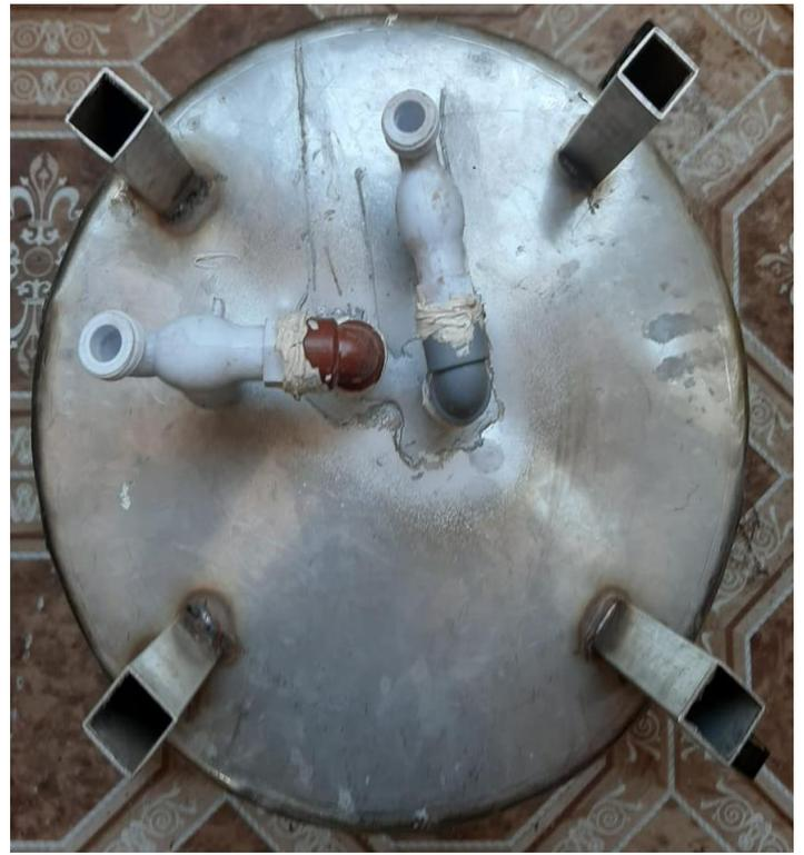
*Figura 10. Salidas de los filtros de sedimentos.*
