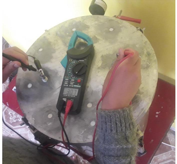
Figura 13. Funcionamiento del regulador de ICC. Figura 14. Medición de voltios con un multítester.
