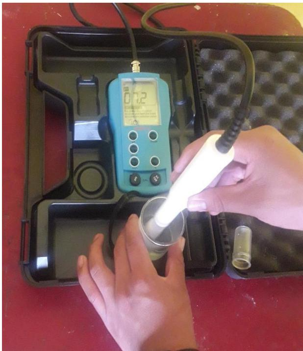
Figura 3. Medición del pH de la muestra patrón.
