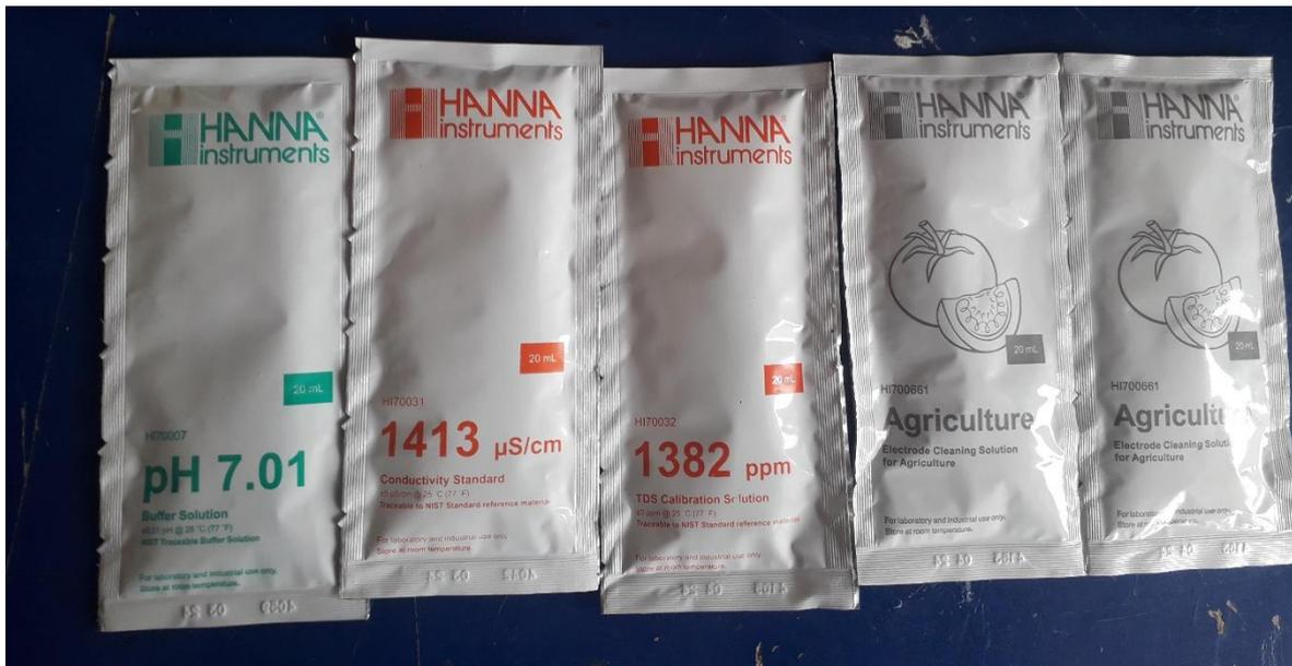
Figura 18. Soluciones de calibración del multiparametro.
