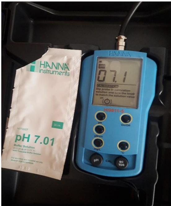
Figura 19. Calibración del pH.
