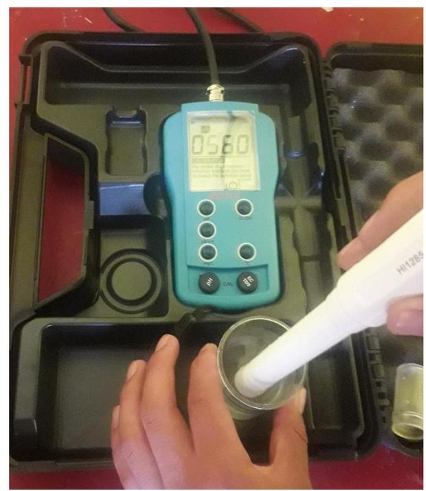
Figura 4. Medición de la CE muestra patrón.
