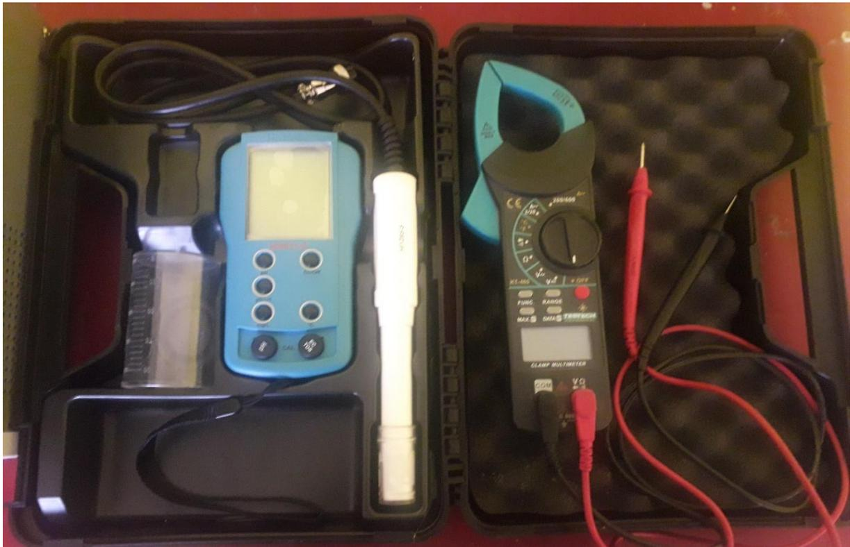
Figura 16. Multiparametro HI 98130 y el multímetro digital 10404 Truper.
