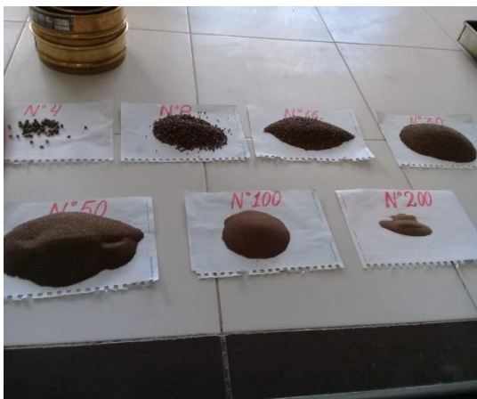
Imagen N°09: EDnsayo de granulometría (fino)
