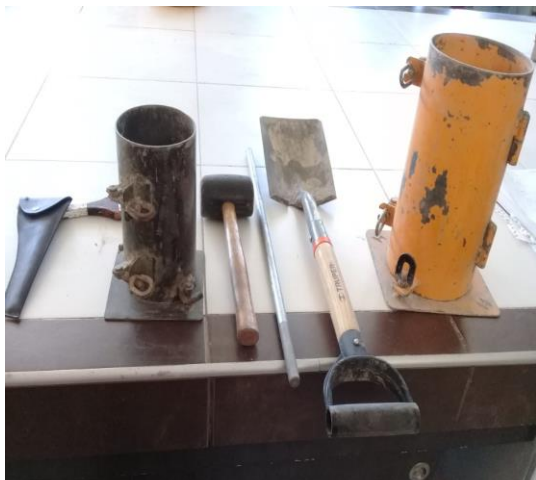
Imagen N°15: Materiales para el ensayo de peso unitario suelto y compacto
