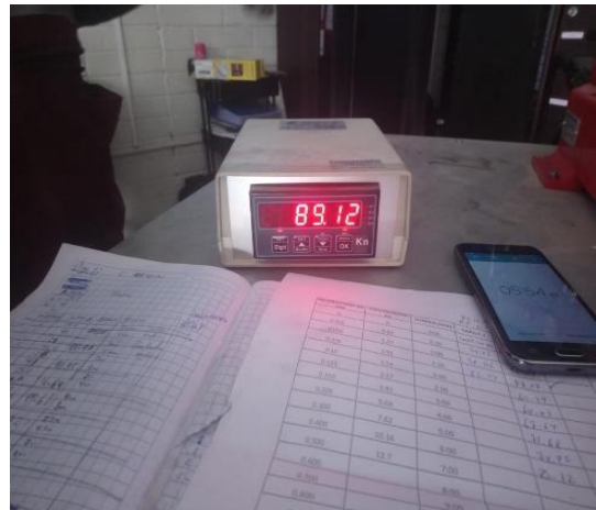
Imagen N°52: Carga máxima de la viga
