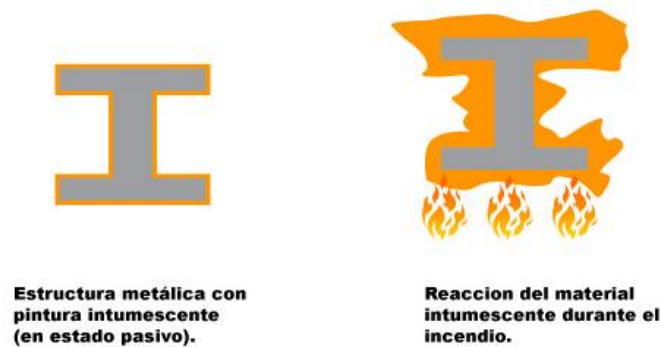
Figura 26. Reacción de la pintura intumescente frente al fuego.
