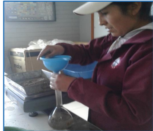
Imagen N°14: Peso de muestra saturada
