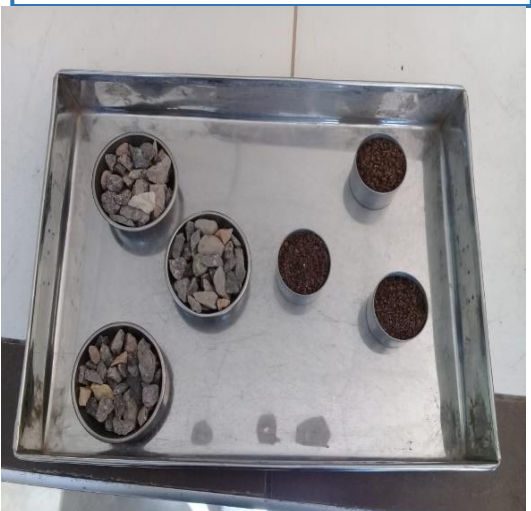
Imagen N°24: Ensayo de contenido de humedad
