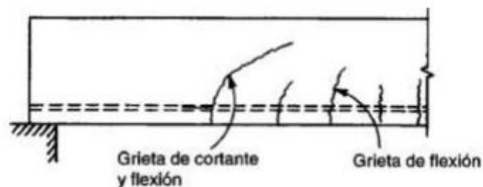
Figura15. Fisuras de corte y flexión en vigas de concreto armado.
