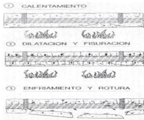
Figura 24. Daños a la adherencia.
