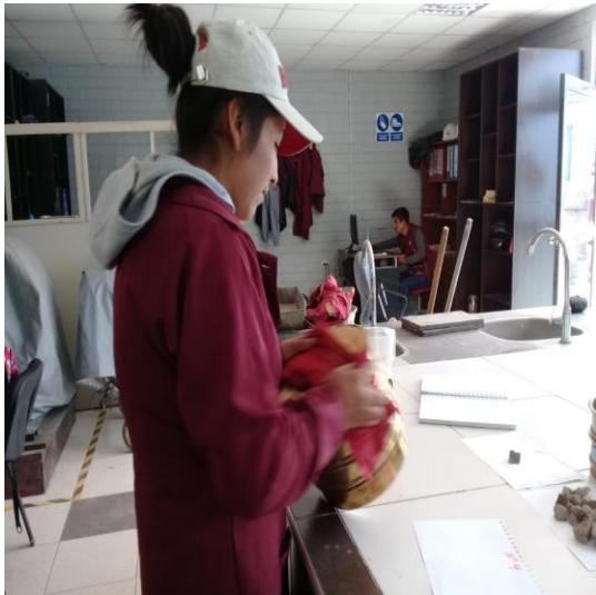
Imagen N°07: Tamizado de agregado grueso
