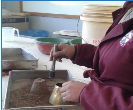
Imagen N°13: Comprobación arena superficialmente seca
