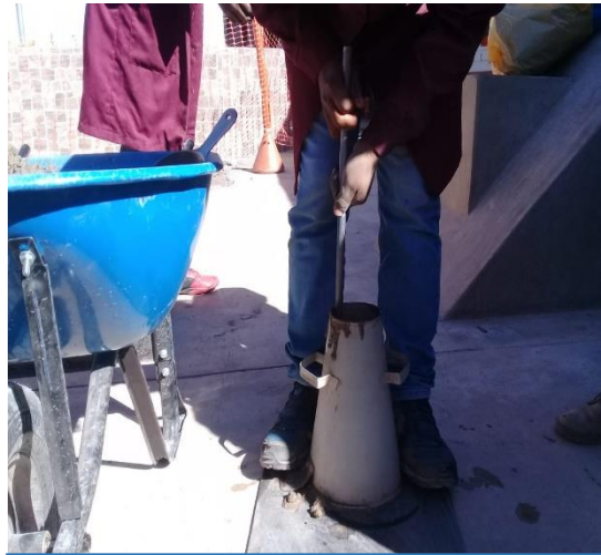
Imagen N°38: Medición de slump que es de 4''
