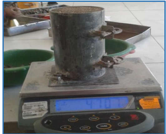
Imagen N°20: Peso de la muestra suelta más molde
