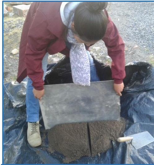
Imagen N°02: Realizando el cuarteo
