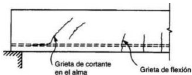
Figura 12. Agrietamiento de corte en el alma.
