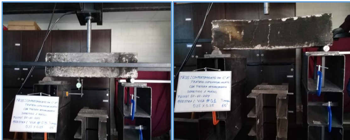
Figura 39. Viga simplemente apoyada.
