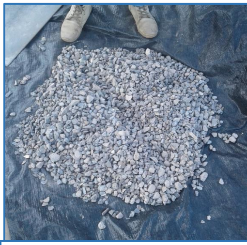
Imagen N°04: Cuarteo de agregado grueso
