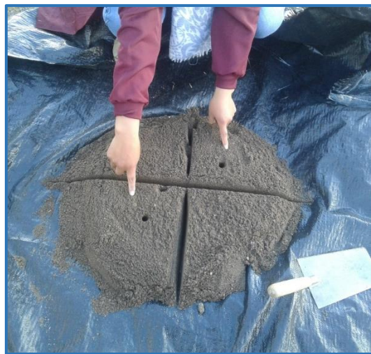
Imagen N°03: Cuarteo de agregado fina
