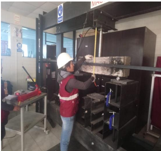
Imagen N°53: Medición de la deflexión
