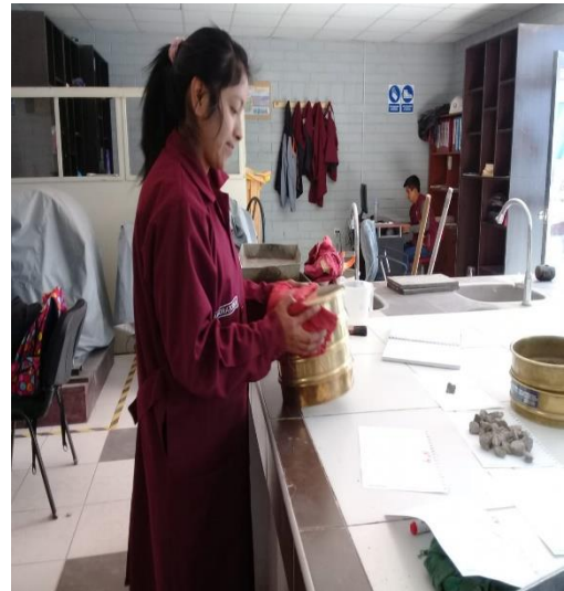
Imagen N°08: Tamizado de agregado fino
