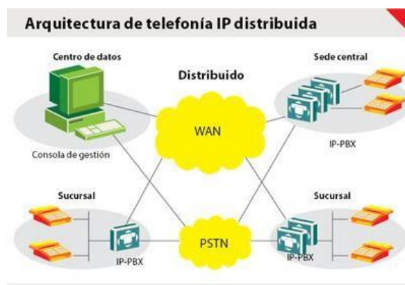
Figura 2. Arquitectura de telefonía IP distribuida. Fuente: (Matango, 2016)
