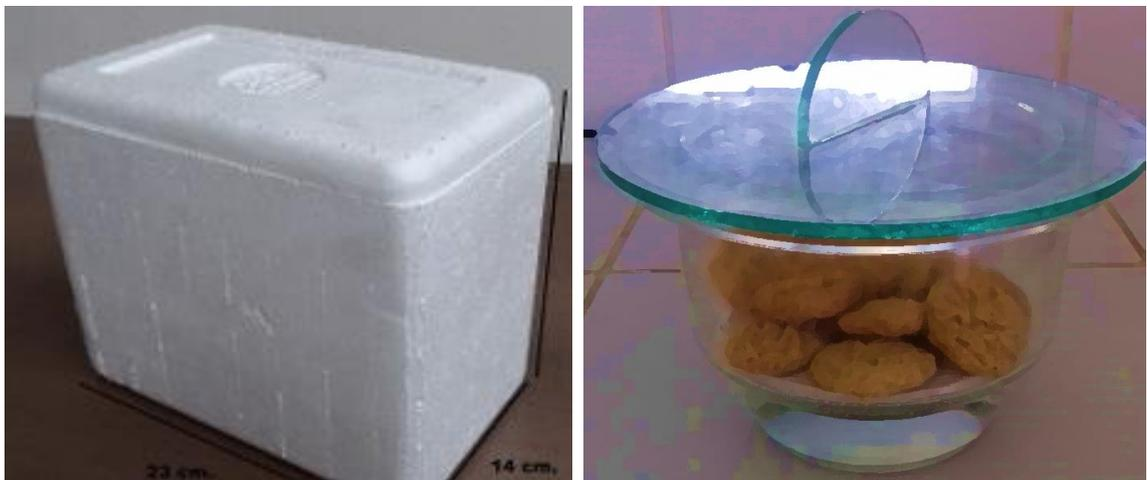
**Figura 9.** Muestras humedecidas en desecador cabina de tecnopor a una temperatura de 30°C
