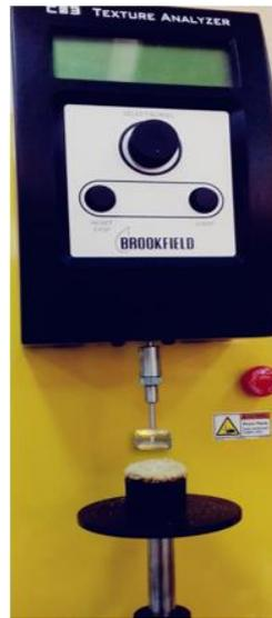
*Figura 10.* Equipo de Brookfield Texturómetro CT3
