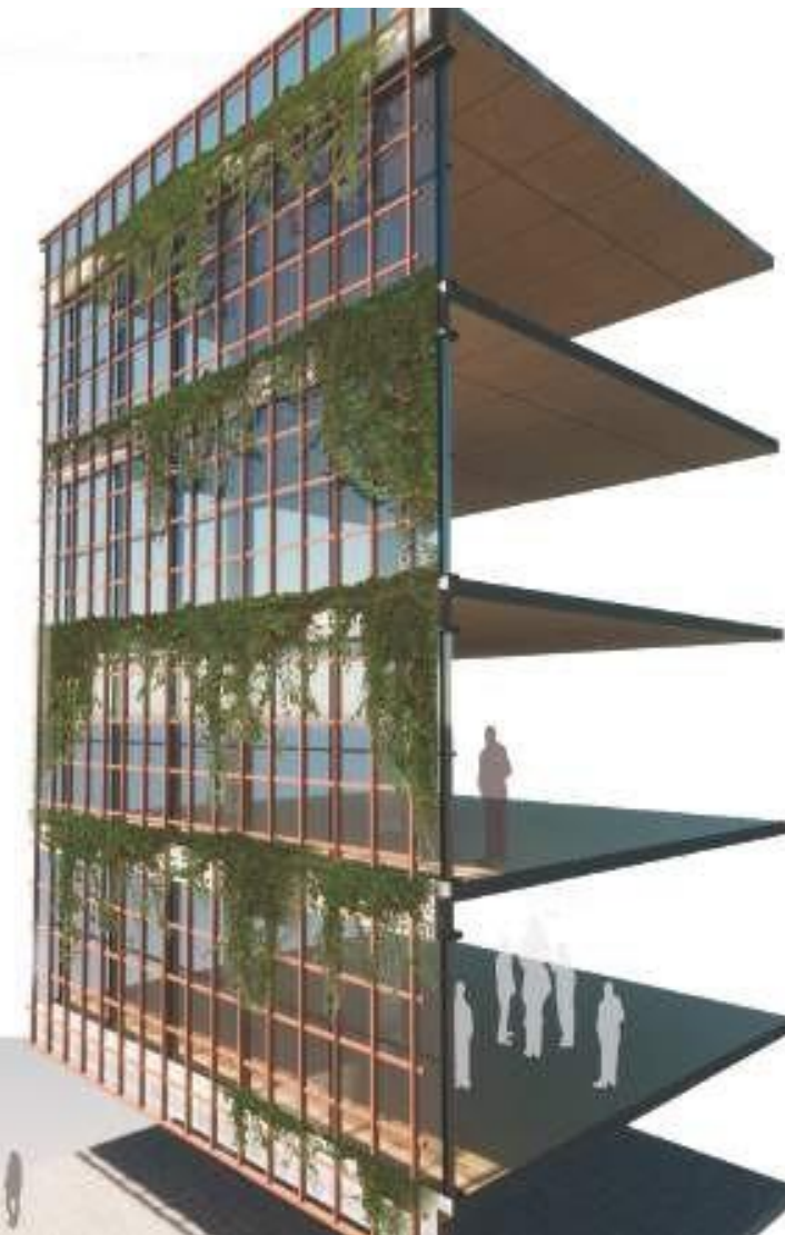
Plano 24. isometria de jardineras colgante en el muro cortina. Fuente: Elaboración propia.
