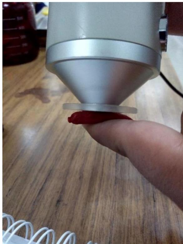
**Imagen 18 – Cuantificación del color en espacio CIEL\*a\*b\* usando un colorímetro, Konica Minolta, modelo CR – 400**
