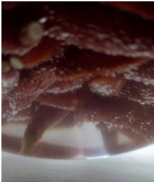
**Imagen 14 – Exposición del ají dulce rojo en encurtido a pulsos de vacío a 200mbar (vista inferior)**
