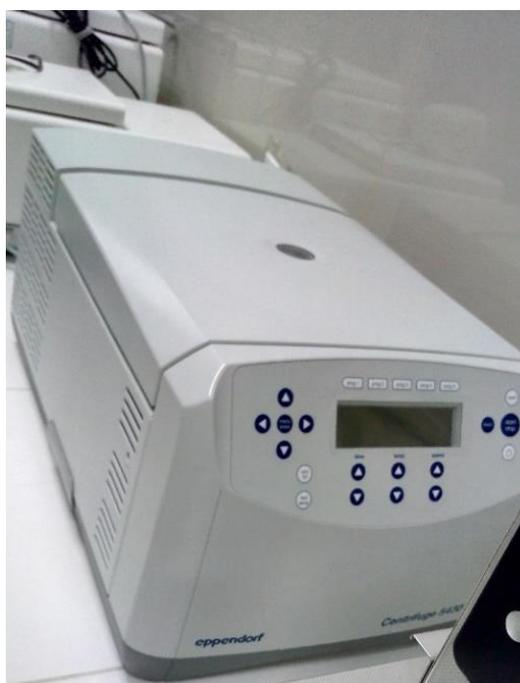
**Imagen 22 – Centrifuga refrigerada eppendorf usada para el análisis de Carotenoides totales**
