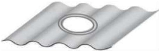
Fig. 1. Demarcación y corte de circunferencia central en lámina
