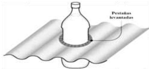
Fig. 4. Ubicación y pre-fijación de la botella a la lámina con el dentado
