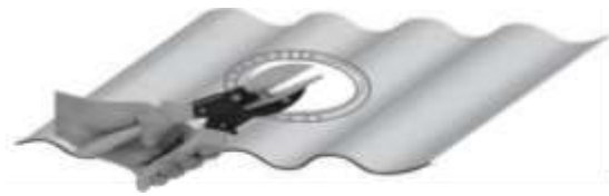
Fig. 2. Cortes transversales de la circunferencia para adentarla
