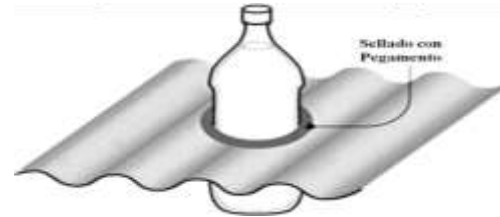
Fig. 5. Fijación de la botella a lámina con pegamento
