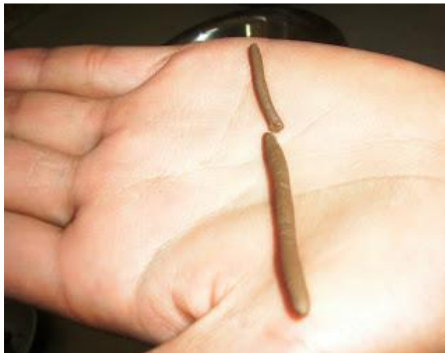
Figura 20. Muestra con signos de grietas, antes de ser pesadas (Elaboración Propia).
