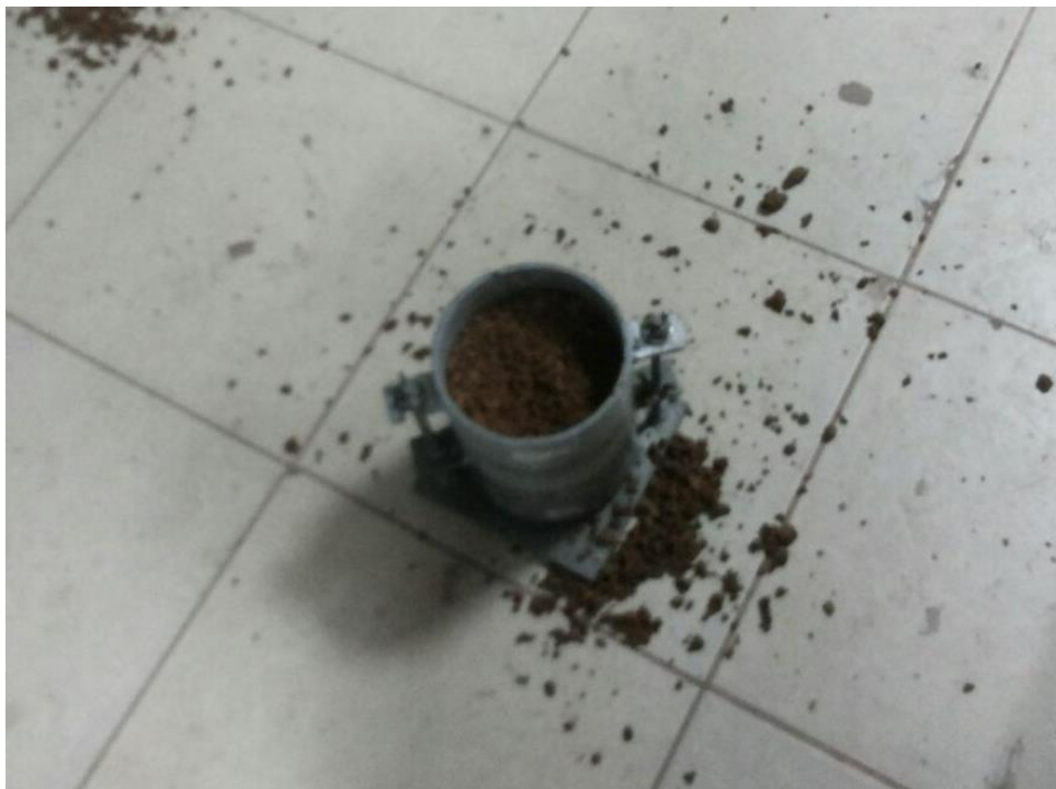
Figura 23. Molde con suelo compactado a punto de ser enrasado para poder pesarlo (Elaboración Propia).
