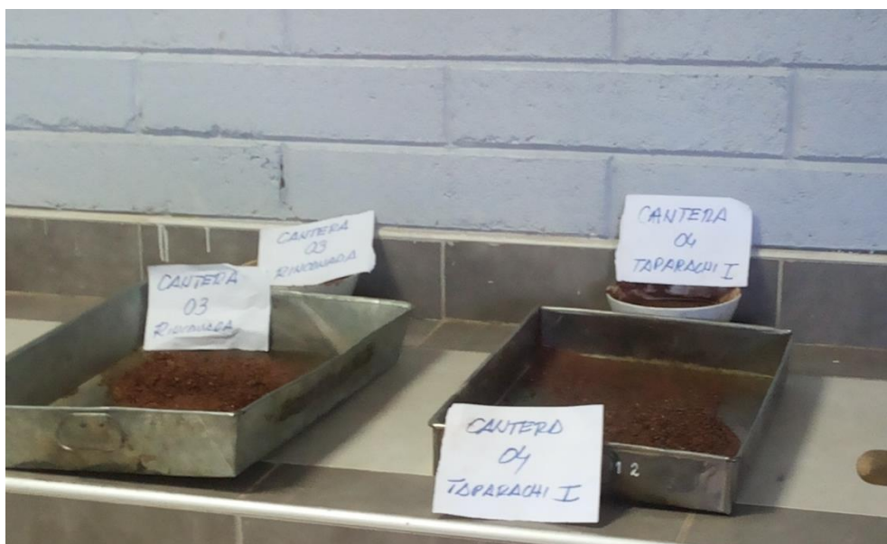
Figura 18. Muestras saturadas listas para los ensayos de límites de consistencia (Elaboración Propia).
