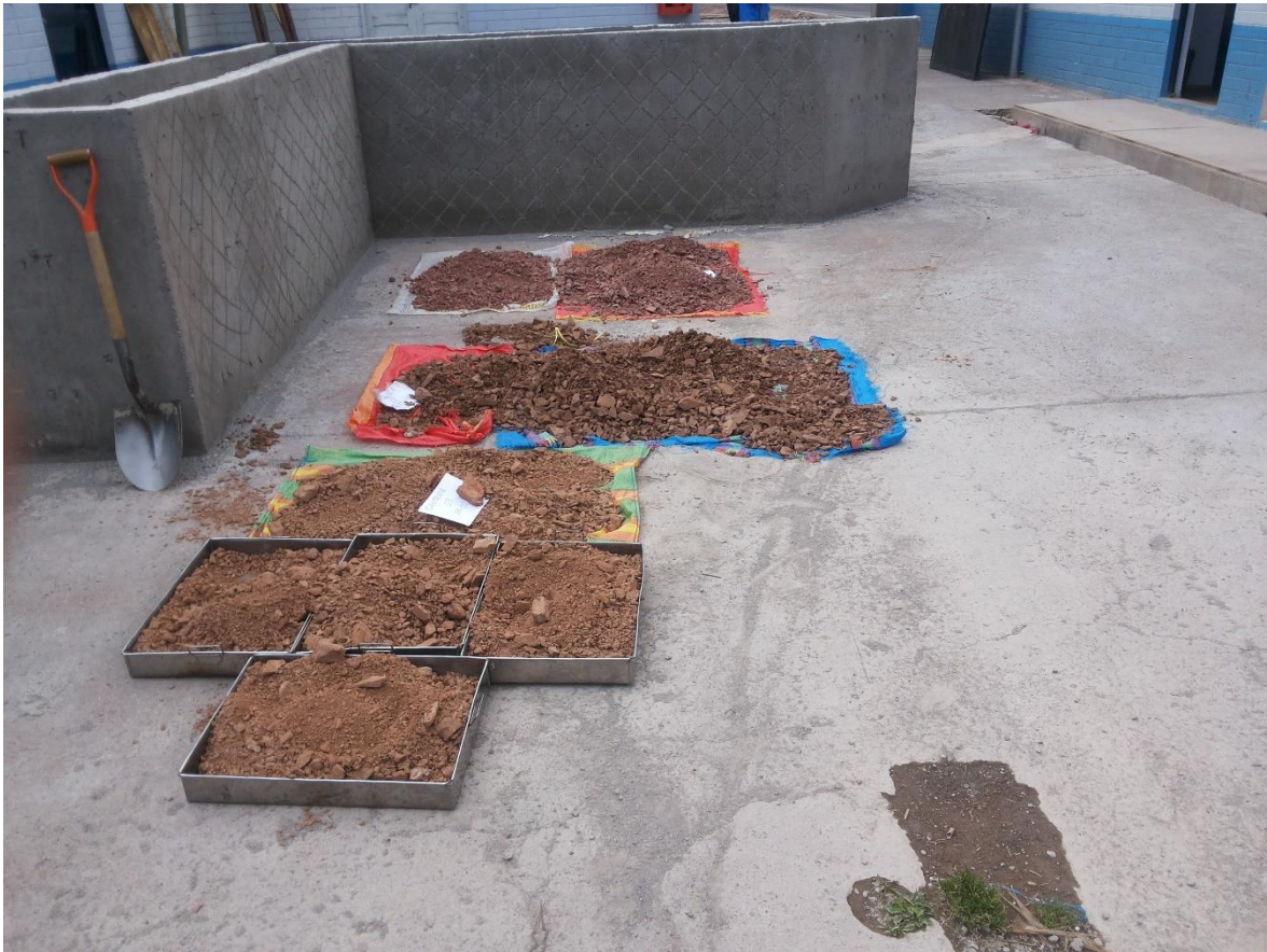
Figura 15. Secado de muestras de las diferentes canteras previo a los ensayos de laboratorio (Elaboración Propia).
