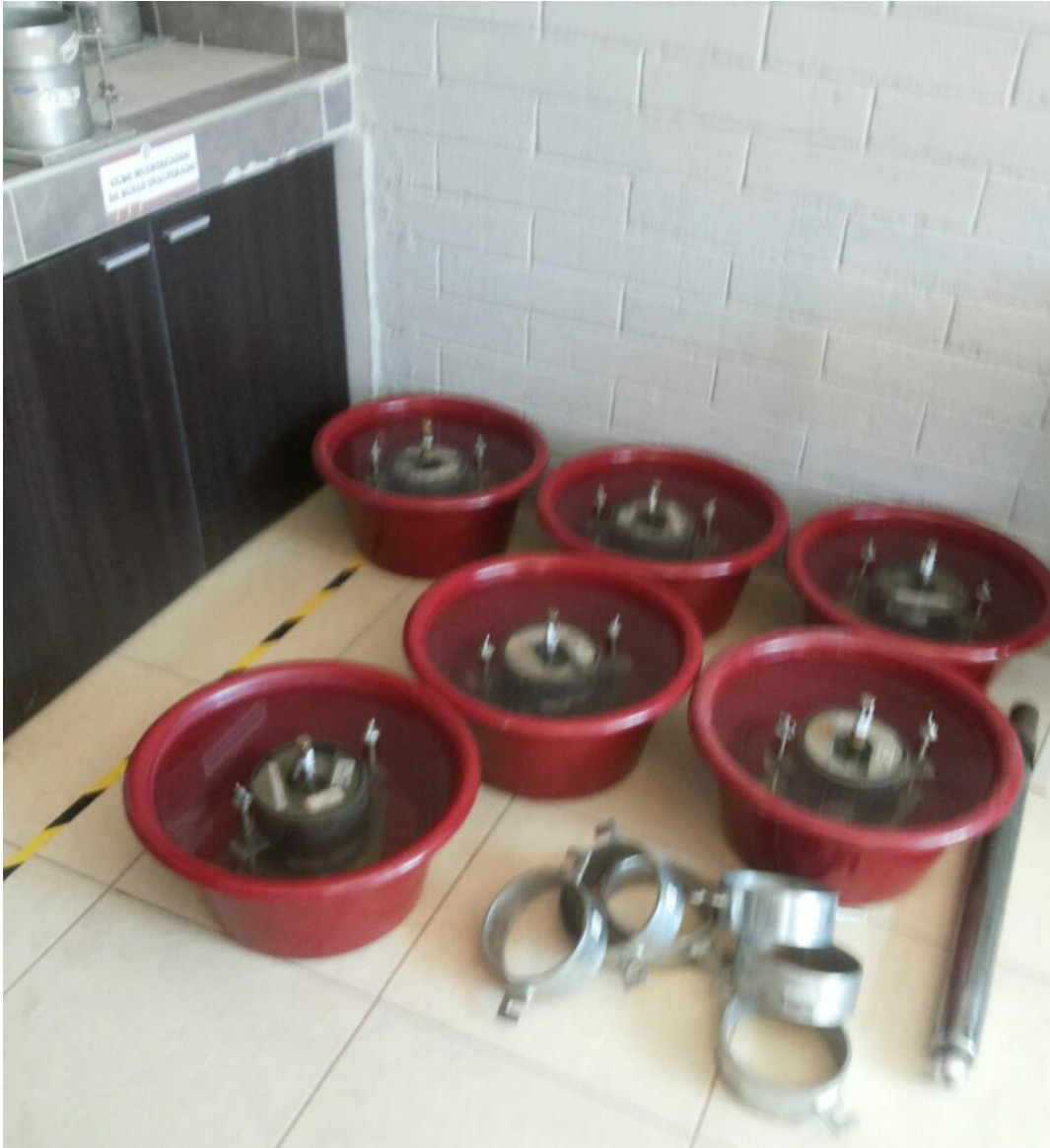
Figura 25. Muestras colocadas en envases de agua proceso de saturación (Elaboración Propia).
