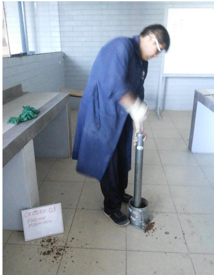
Figura 22. Compactación del suelo a 56 golpes por capa (Elaboración Propia)
