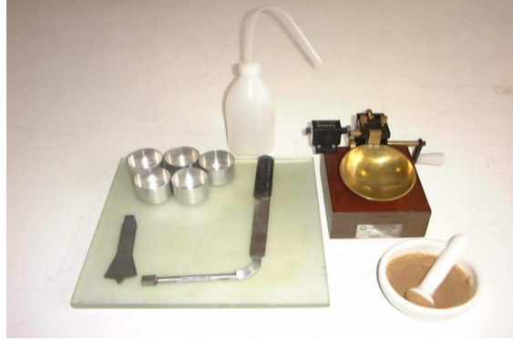
Figura 19. Cuchara de casa grande, ranurador, espátulas, pipeta, taras, vidrio esmerilado, recipientes de porcelana
