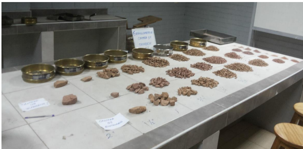
Figura 17. Material tamizado y tamices 3", 2 1/2", 2", 1 1/2", 1", 3/4", 1/2", 3/8", 1/4", N° 4, N° 10, N° 20, N° 40, N° 100, N° 200 (Elaboración Propia).
