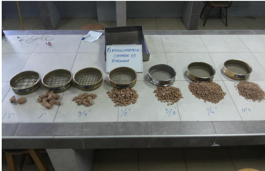
Figura 16. Material retenido en cada tamiz mayores al tamiz N° 4, cantera 03 Rinconada (Elaboración Propia).
