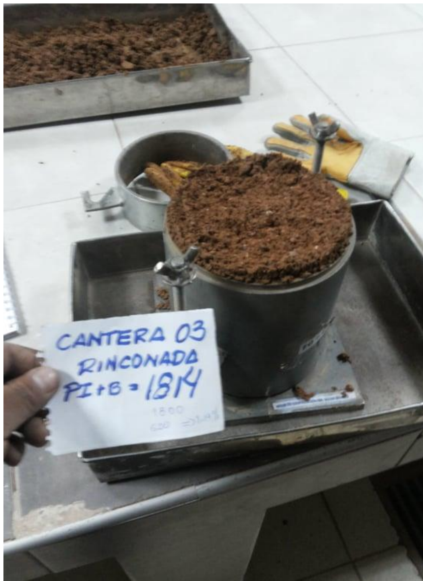
Figura 24. Molde de CBR con muestra compactada, en la parte inferior el espaciador y a un costado el collarín muestra lista para enrasarlo (Elaboración Propia).
