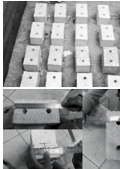
Ladrillos ecológicos elaborados a partir de papel, secado de los bloques de papel, medición de las dimensiones del ladrillo. (ver figura 40)
