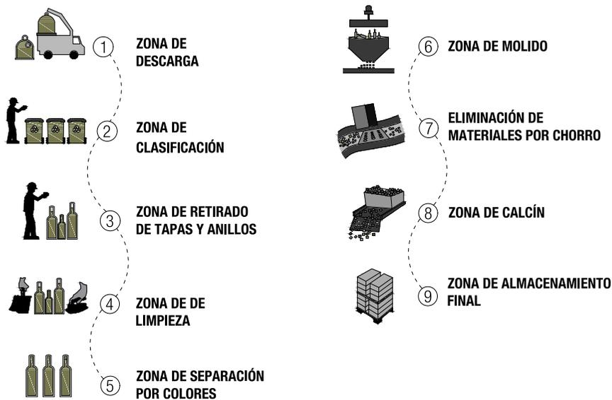
Figura 25. Esquema del vidrio reciclado
