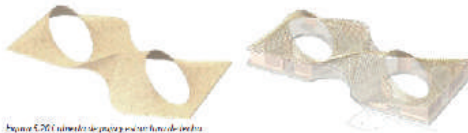
Figura 5.20 Cubierta de paja y estructura de bambú Fuente: Elaboración propia, 2019
