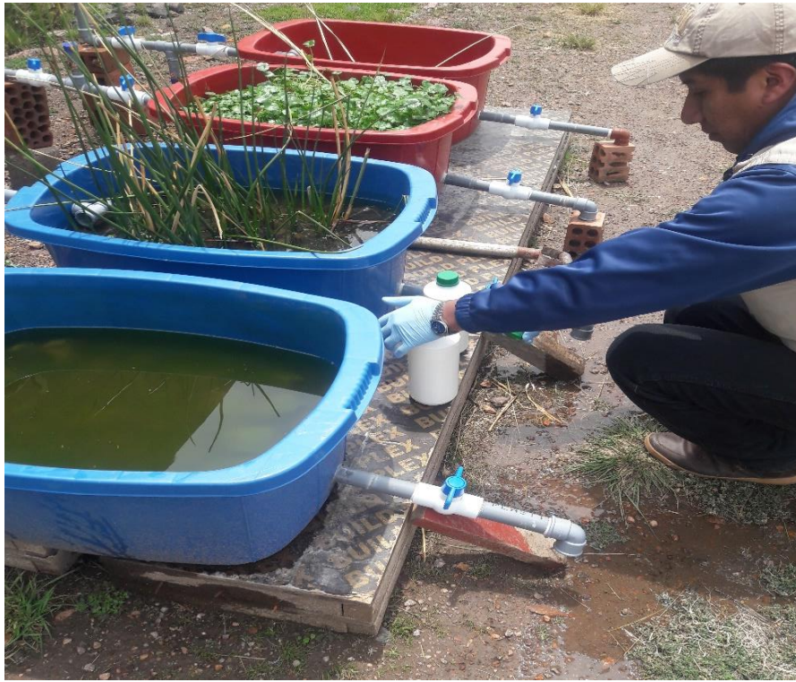
Figura 26. Muestreo de aguas residuales del sistema de tratamiento
