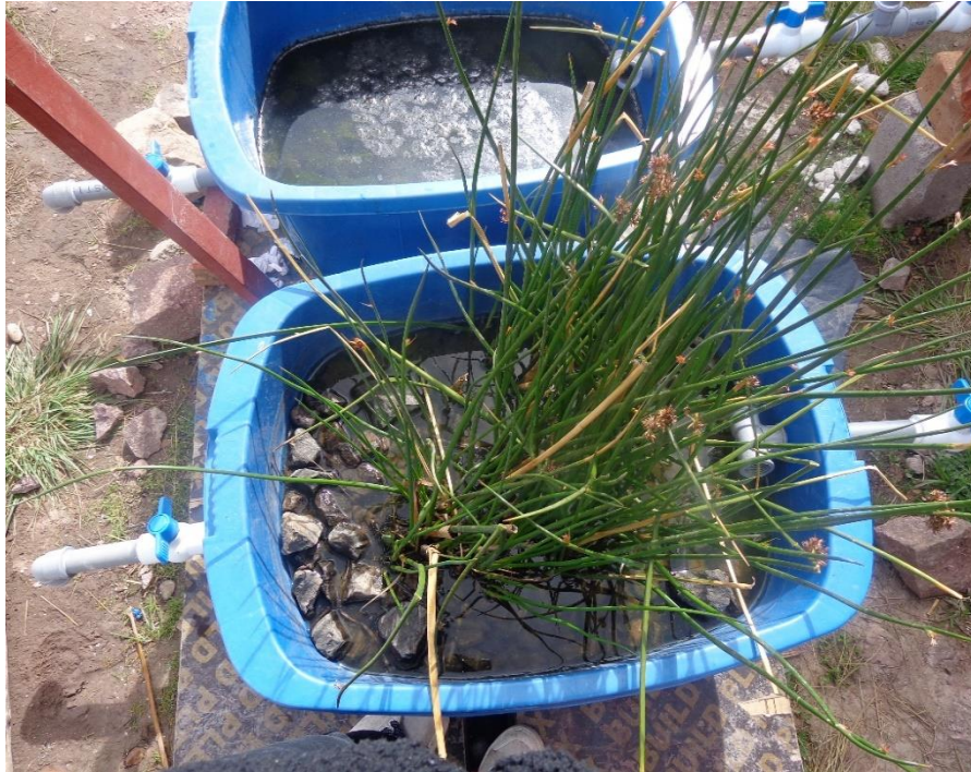
Figura 35. Humedal artificial de flujo subsuperficial con la especie Schoenoplectus Californicus (Totora)
