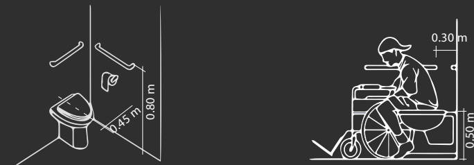
Gráfico 4.25: INODORO. Fuente: Norma Técnica A.120, MVCS, 2019
