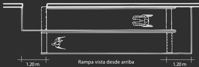
Gráfico 4.50: RAMPA - PLANTA. Fuente: Norma Técnica A.120, MVCS, 2019
