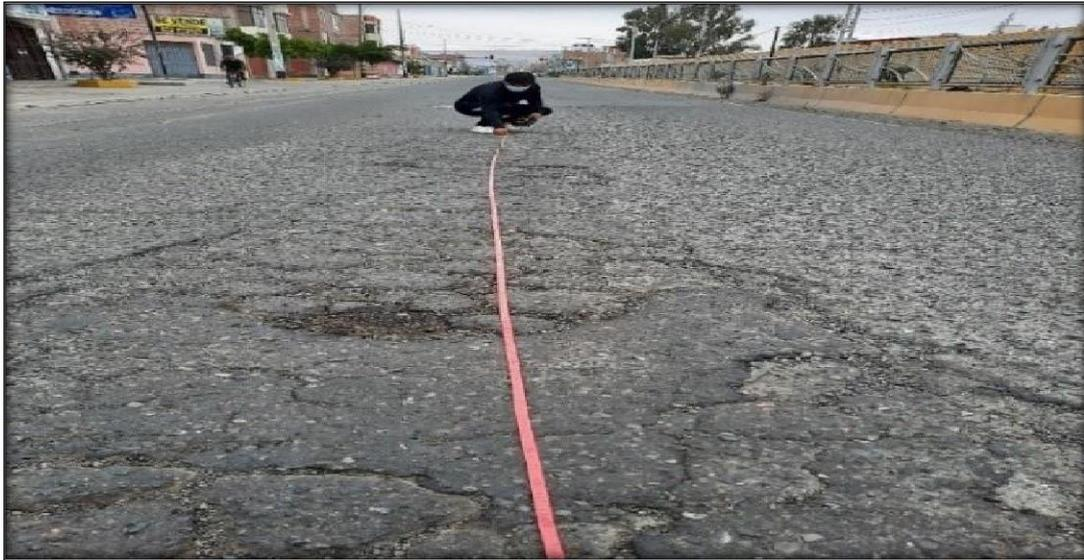
*Figura 5.* Cinta métrica de 50 metros para medición de fallas.
