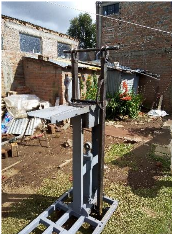
Fotografía 14. Armado de los componentes mecánicos a la estructura metálica.
