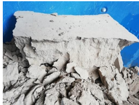
Figura 25. Fisuras presentadas en los lados laterales de los bloques
