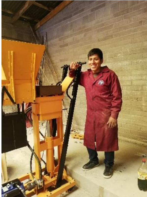
Fotografía 17. Equipo hidráulico completamente terminado elaborando los BTMD.
