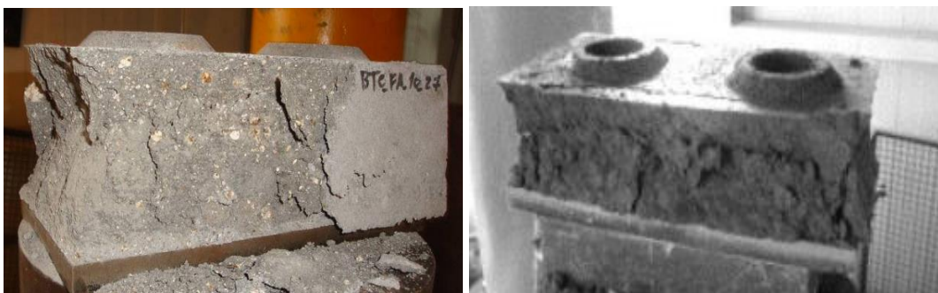
Figura 11. Falla típica de un bloque sólido presentando deformaciones laterales.
