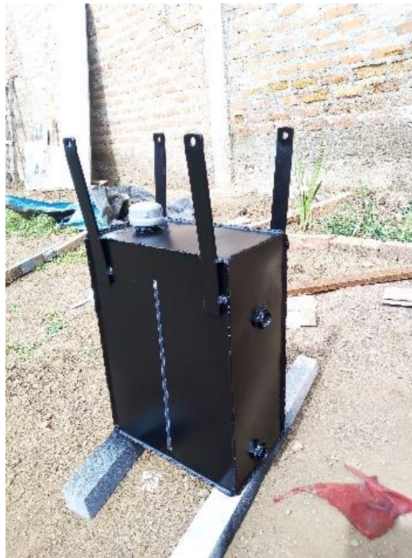
Fotografía 6. Acabado final del depósito de hidrolina.
