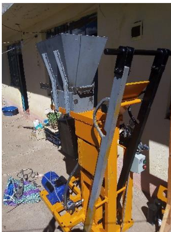
Fotografía 16. Instalación de los componentes mecánicos e hidráulicos, con el motor eléctrico al equipo elaborador de BTMD.
