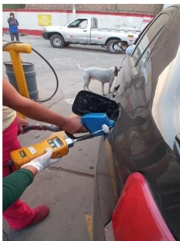
Figura 4. Monitoreo de COVs, evaporaciones fugitivas en el despacho de combustible.
