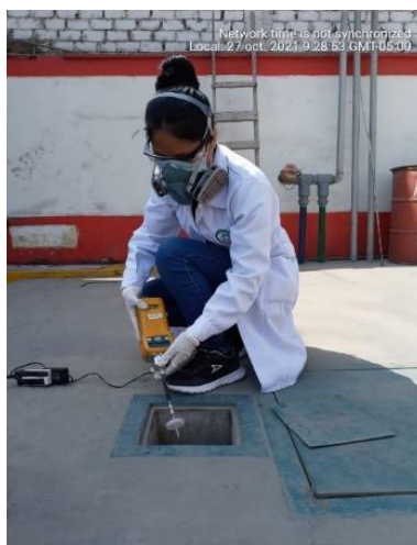
Figura 3. Monitoreo de COVs, en tanques subterráneos de combustibles.
