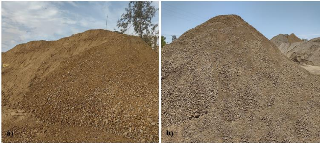
Figura 2. Lugar de Acopio del material granular de la cantera BASTIAN. Fuente: los autores Siendo este evaluado mediante ensayos de laboratorio en “E & ZU INGENIEROS E.I.R.L.” presentado en Tabla 8, el material presentan una granulometría continua, bien graduada y según los requerimientos de una de las franja granulométricas para bases granulares.
