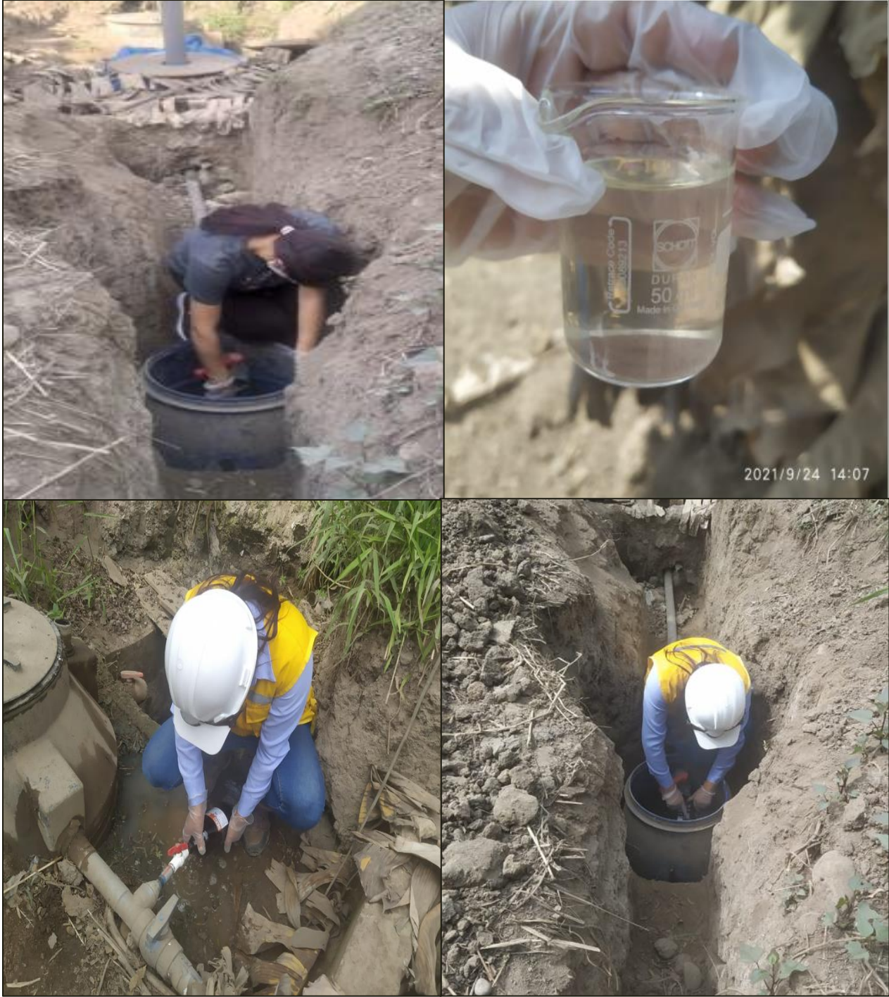
Anexo 35: Toma de muestras de agua residual domestica tratada para su posterior análisis en laboratorio.
