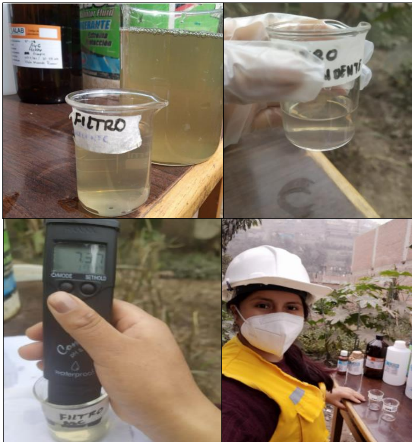
Anexo 34: Análisis del agua de los parámetros in situ de pH, T°, conductividad eléctrica y TDS del residual domestica tratada.
