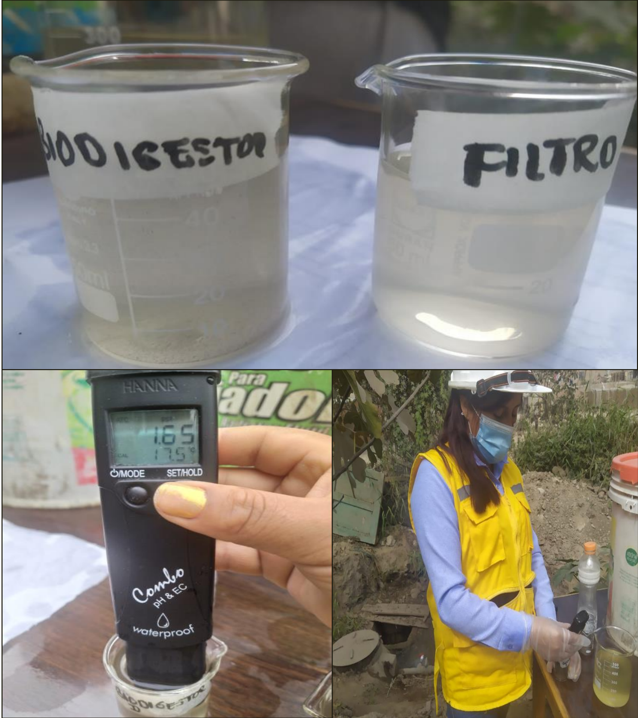
Anexo 33: Medición de los parámetros de campo empleando el equipo portátil multiparámetro marca HANNA.
