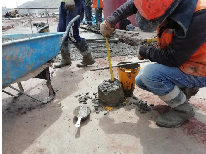
Figura 25. Verificación del Slump
