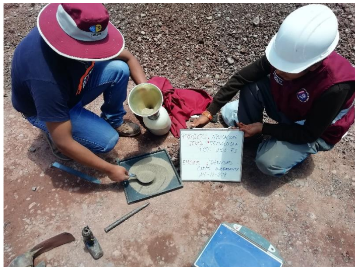
Figura 23. Ensayo de densidad de campo mediante cono de arena
