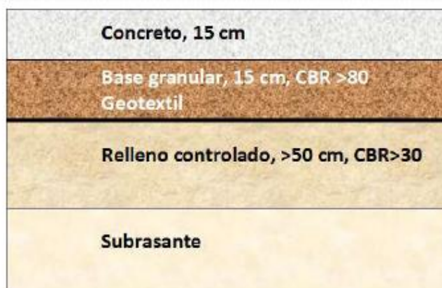
Figura 6. Esquema típico de un pavimento con una subrasante elevada.
