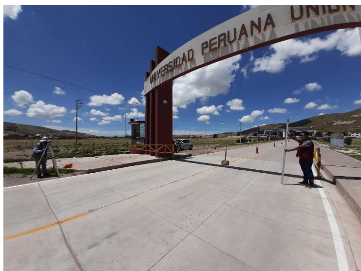
Figura 35. Levantamiento topográfico para determinar el IRI
