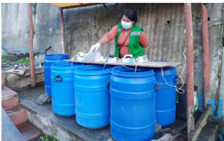
Figura 1. Muestra de la instalación de los reactores de ME, MM y el blanco o control.
