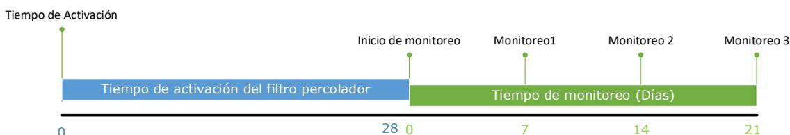
Figura 3. Línea de tiempo del Proceso de tratamiento del agua residual
