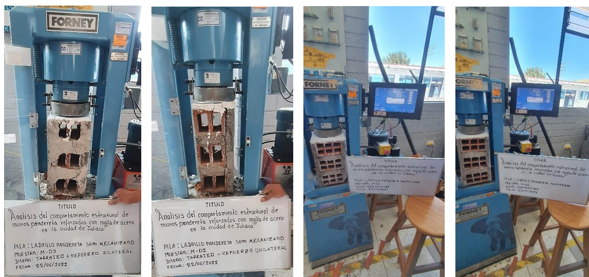
Figura 7: Ensayo de compresión axial de pilas.
