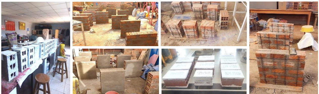
Figura 2: Muros y pilas según el diseño de refuerzo.
