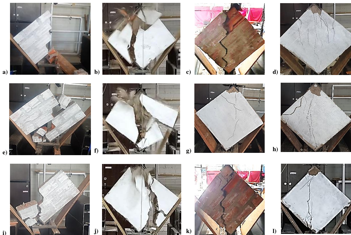
Figura 12: Tipo de falla en muros pandereta, según el tipo de diseño.
