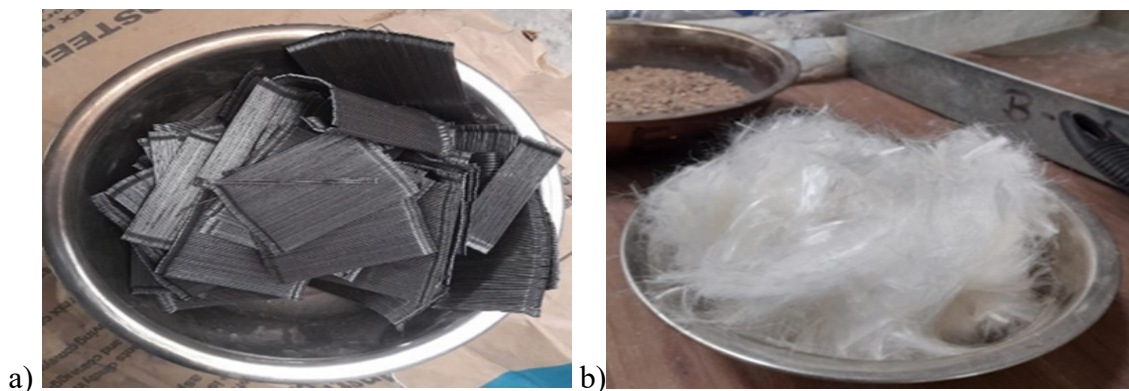
Figura 2. a) Fibra de acero b) Fibra de polipropileno. Fuente: el autor
