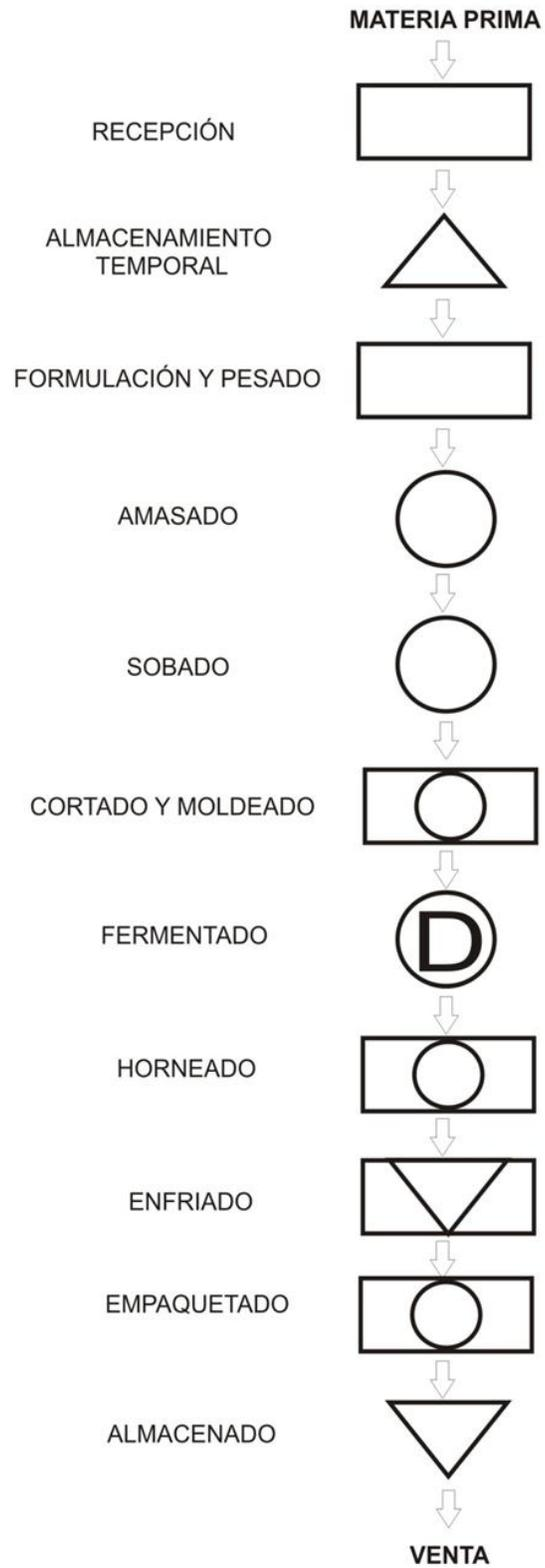
*Figura 18: Diagrama de Proceso para la elaboración de Pan.*
