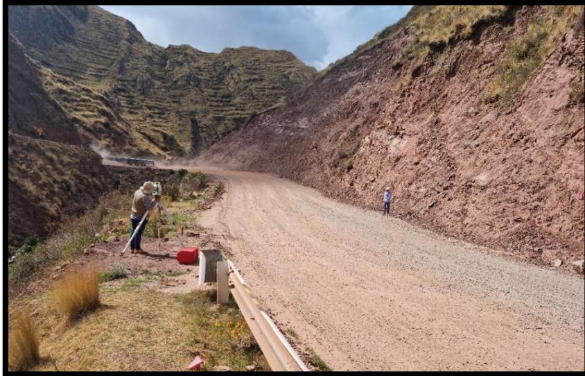
Figura 13. Levantamiento de pendientes en la carretera.
