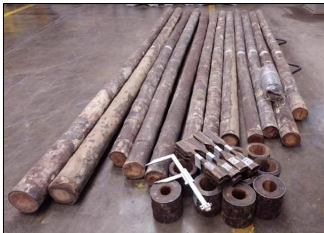
Figura 4. Probetas de Camona para los ensayos.
