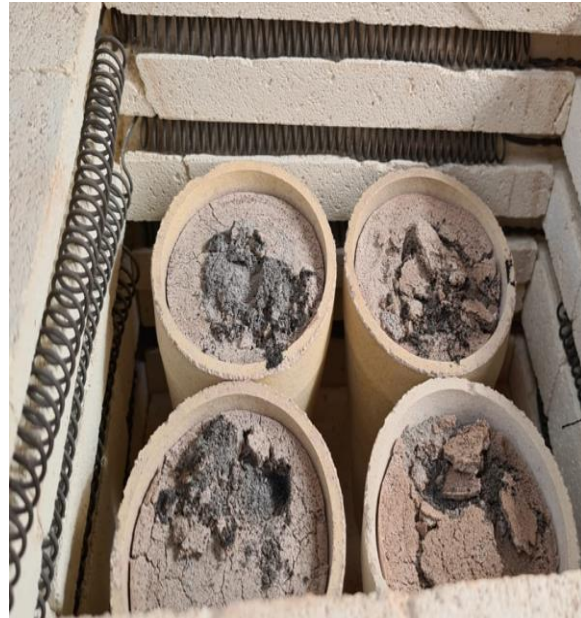
Fotografía 4. Ceniza de la cáscara de nuez sacado del horno.
