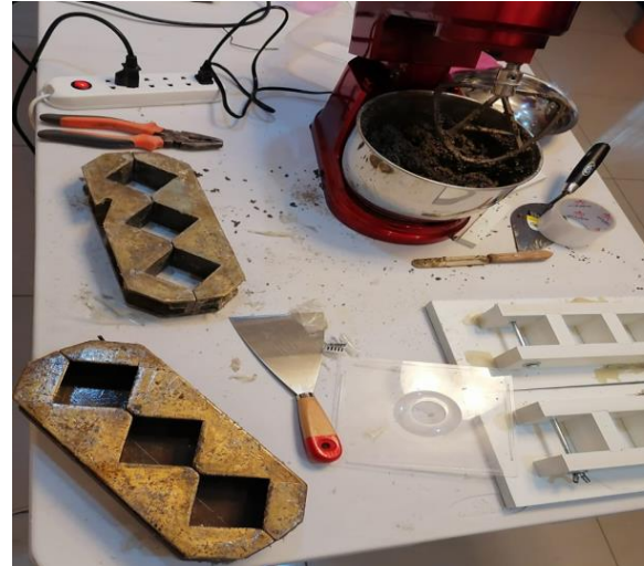
Fotografía 6. Moldes para los cubos de 50 mm de lado.
