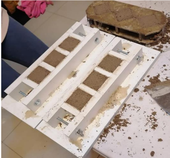
Fotografía 5. Elaboración de los cubos de 50 mm de lado.
