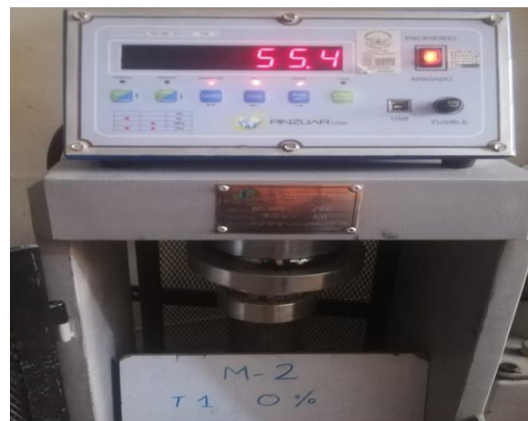
Fotografía 10. Rotura de los cubos de 50 mm.
