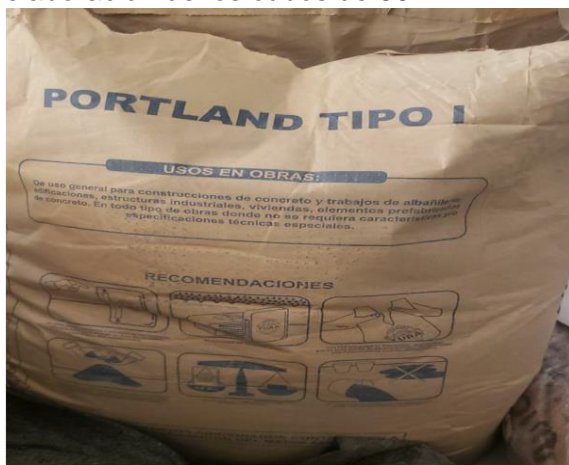
Fotografía 9. Tipo de cemento Portland Tipo 1 utilizado para la mezcla.
