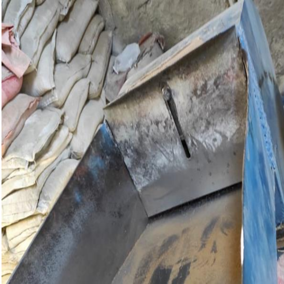
Fotografía 1. Trituración mecánica de la cáscara de nuez.
