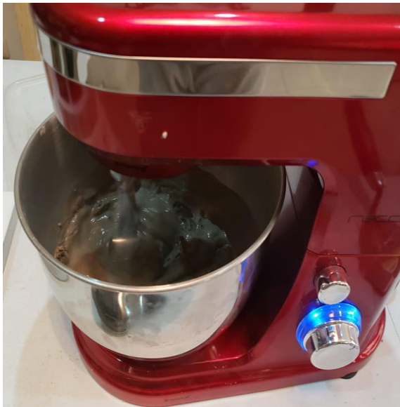
Fotografía 7. Máquina mezcladora para la elaboración de los cubos de 50 mm.
