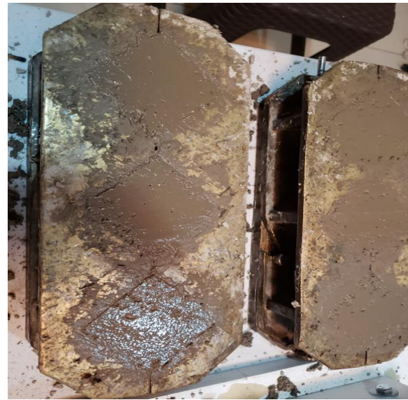
Fotografía 8. Elaboración de los cubos de 50 mm en su respectivo molde.
